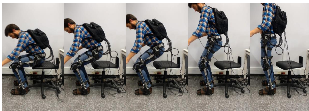
Figura 3.3.- Persona sana realitzant el moviment d'aixecar-se d'una cadira gràcies a l'exosquelet H1.
