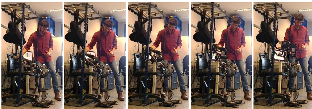
Figura 3.2.- Exosquelet H1 realitzant el procés d'aixecar-se d'una cadira.
