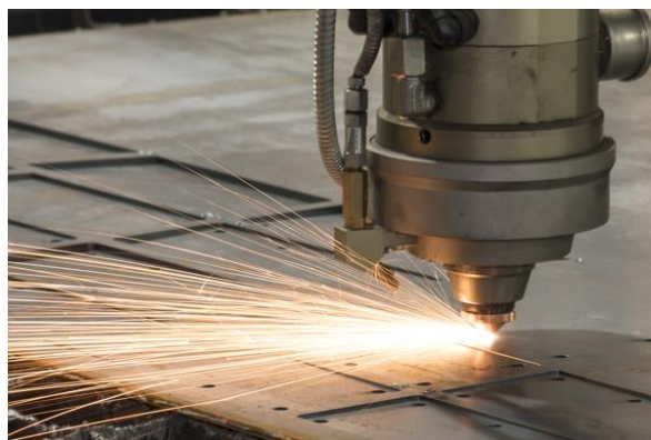
Figura 2.5. Tallar metall amb làser. Font: http://www.provimetal.cl/images/corte-laser-menu.jpg
