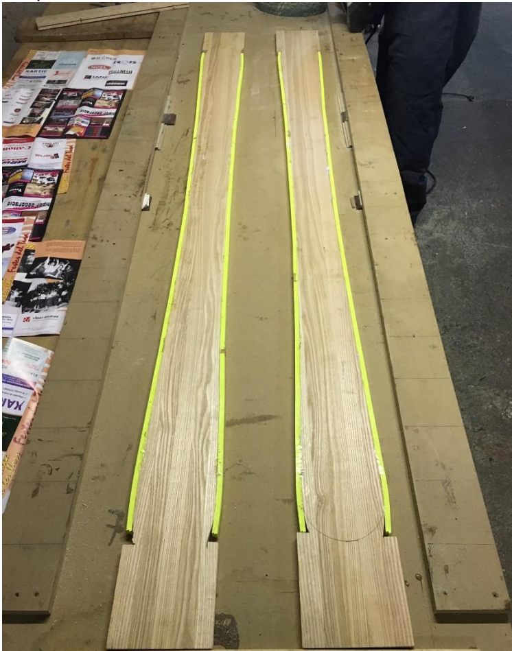
Figura 78 Nuclis amb els sidewalls enganxats
