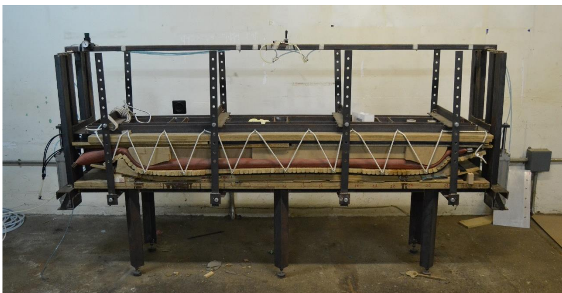
Figura 88 Premsa amb les mànegues inflades durant la curació de la resina.
