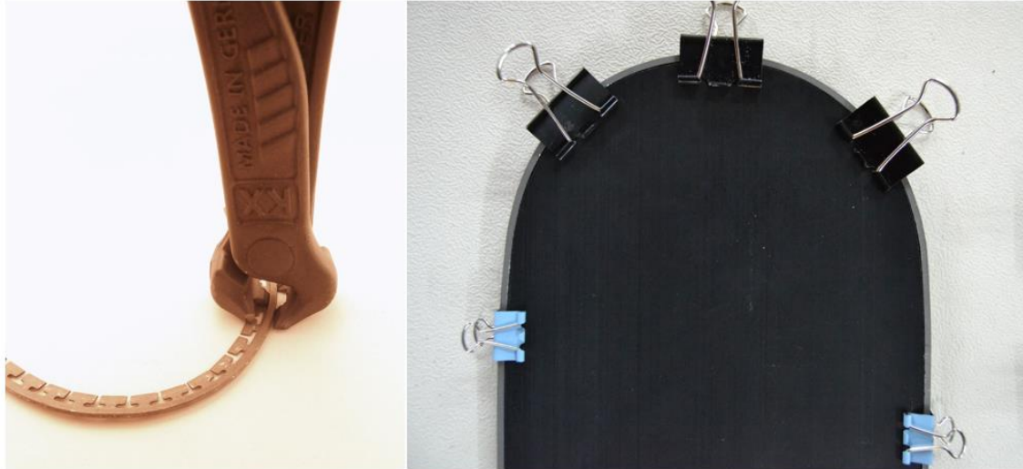
Figura 72 Eina per doblar cantells (esquerra) i cantell adaptat a la geometria del tip de l'esquí (dreta)
