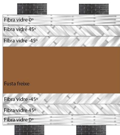
Figura 64 Secció amb tires de fibra de carboni
