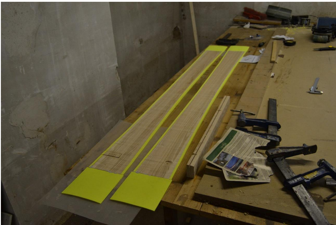
Figura 82 Nucli amb els sidewalls enganxats i preparats per a la laminació.
