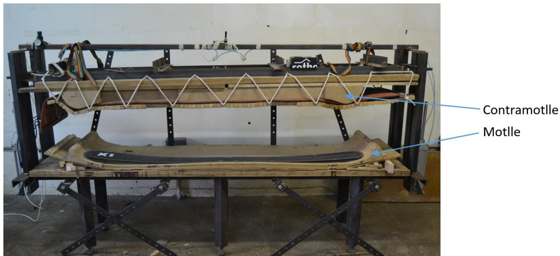
Figura 83 Premsa preparada amb les cotes adequades per premsar l'esquí.
