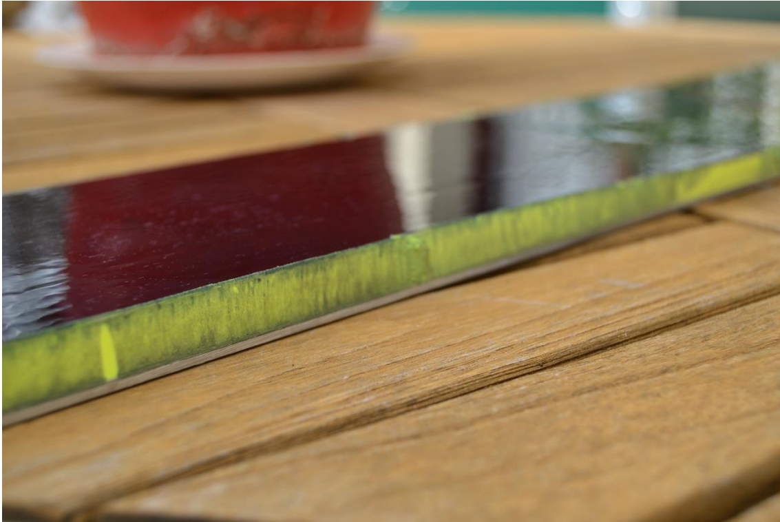
Figura 90 Sidewall de l'esquí un cop ha estat tallat amb la serra elèctrica. Cal destacar el seu acabat de color negre degut al fregament.
