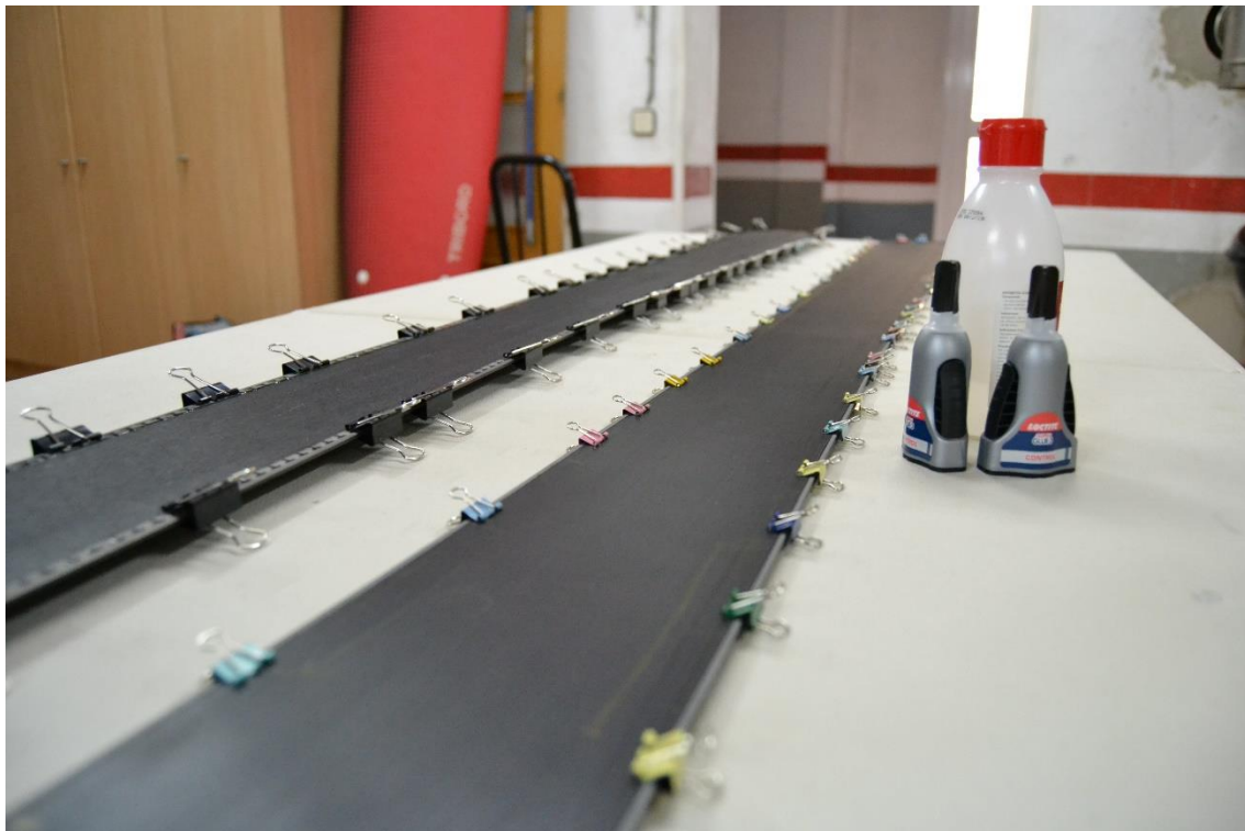
Figura 73 Bases amb els cantells units amb cola de contacte
