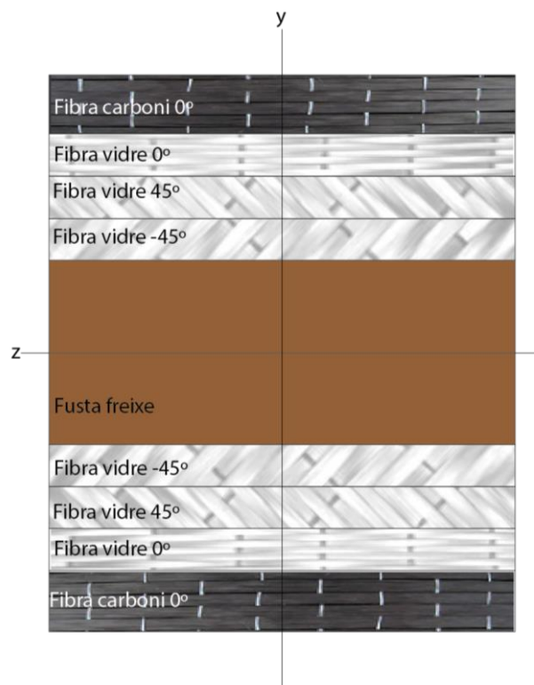
Figura 47 Secció de l'esquí formada per diferents materials
