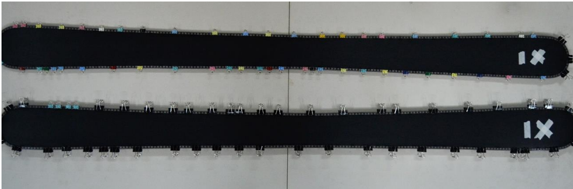
Figura 74 Bases dels esquís amb els cantells enganxats
