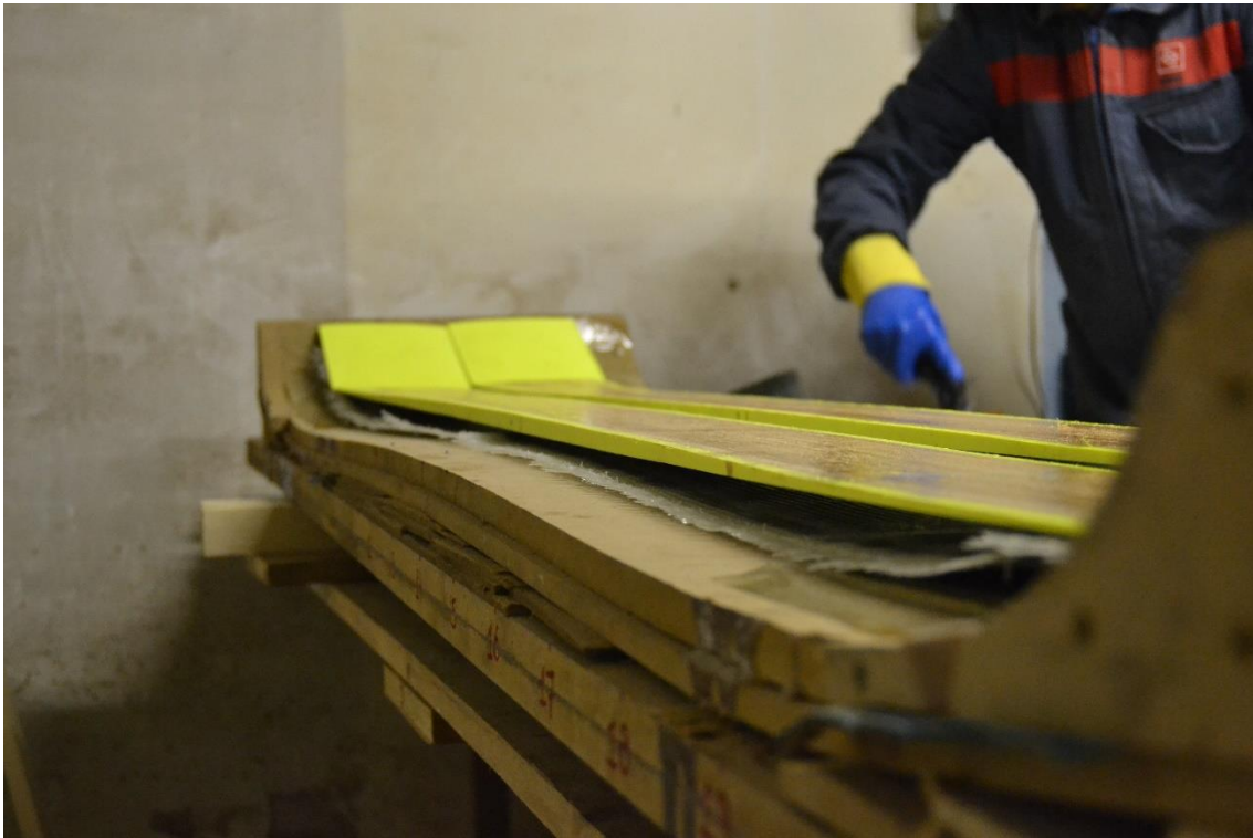
Figura 86 Nuclis de l'esquí durant el procés de laminat.
