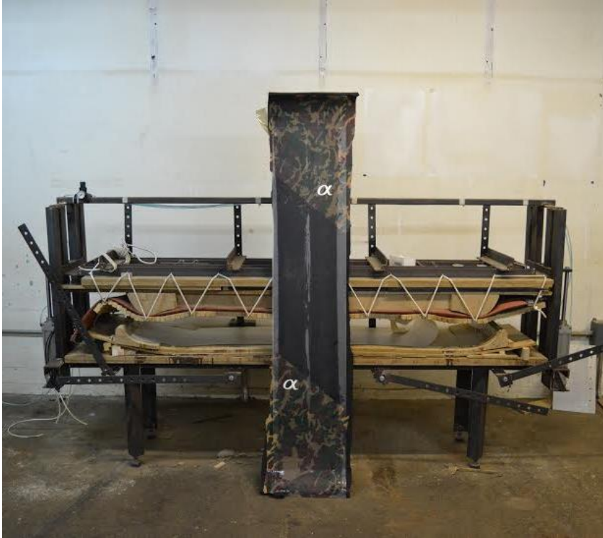
Figura 89 Esquís un cop ha finalitzat la curació de la resina.
