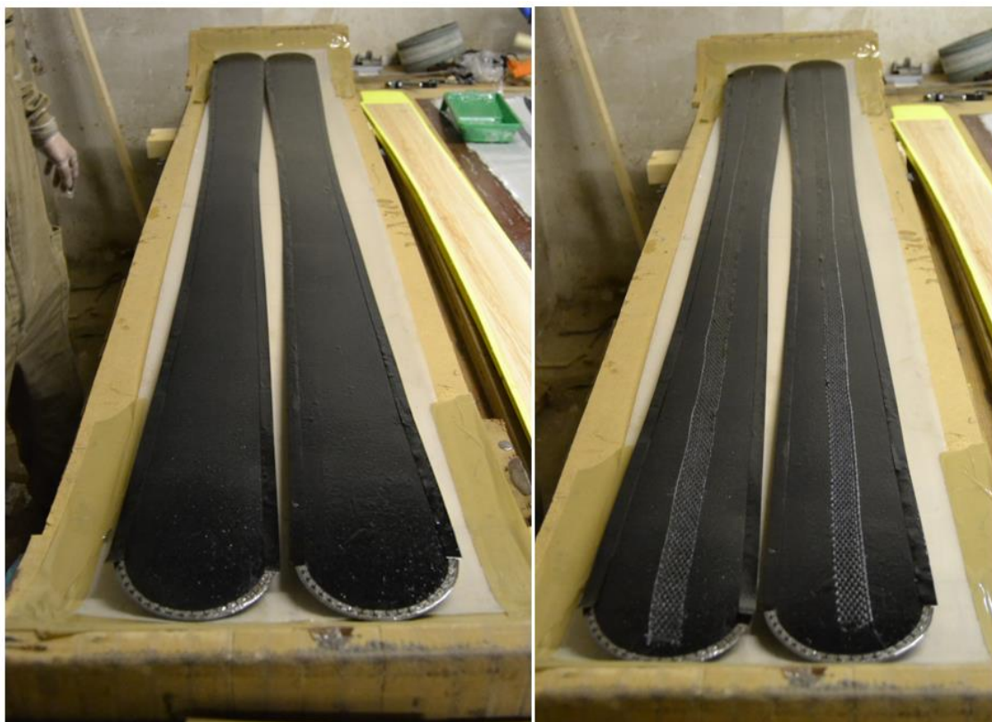
Figura 85 Bases amb gomes VDS (esquerre) i fibra de carboni (dreta)
