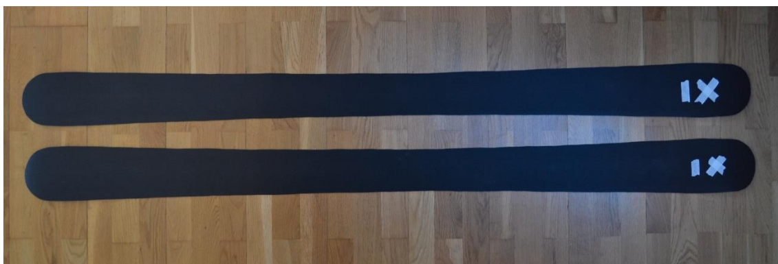
Figura 71 Bases de polietilè tallades segons la geometria de l'esquí
