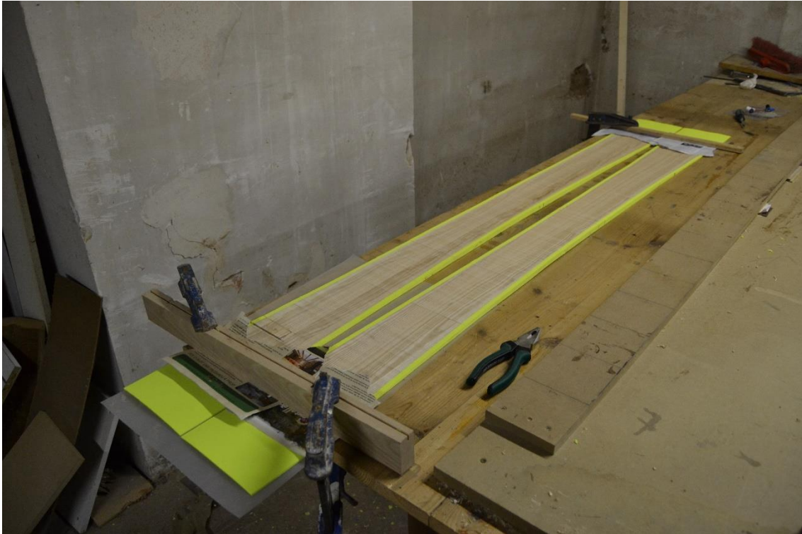
Figura 81 Nuclis fresats i amb els tipspacers enganxant-se
