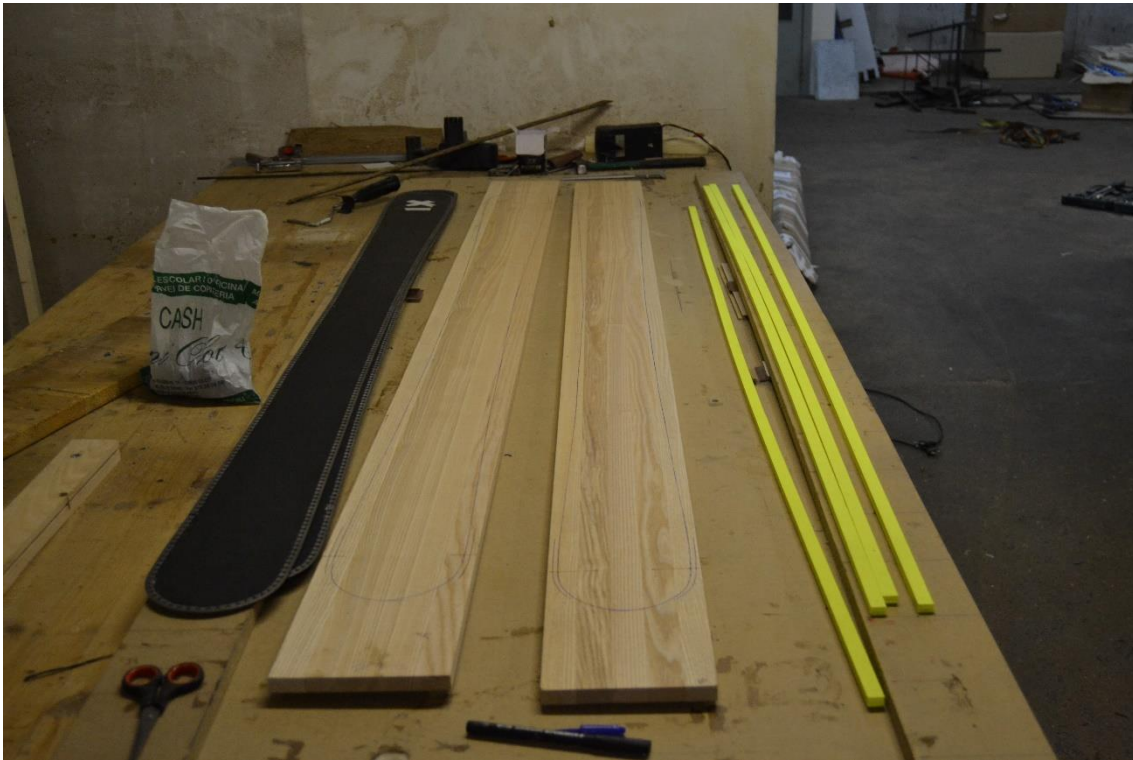
Figura 75 Bases de l'esquí (esquerra), nuclis sense tallar (centre) i sidewalls sense enganxar (dreta)
