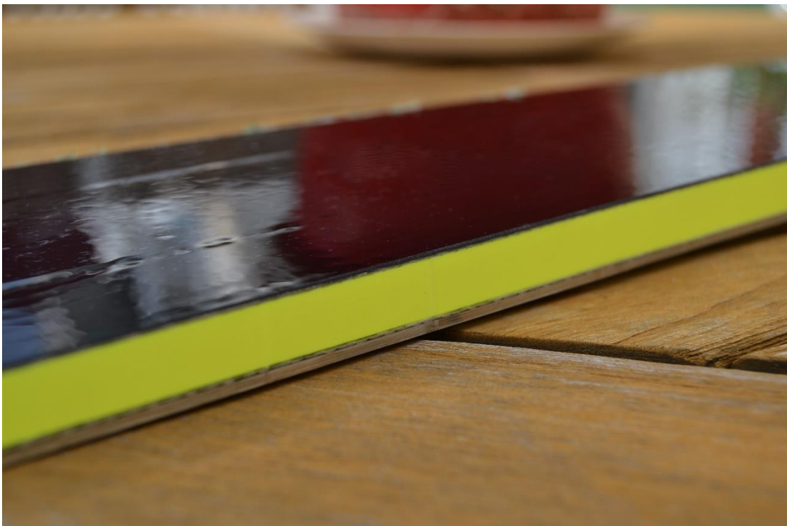
Figura 91 Sidewall de l'esquí un cop polit i fresat. Cal destacar el seu acabat brillant i llis.
