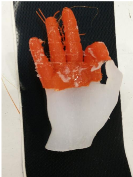
Figura 40. Producte Mà amb la meitat de la carcassa rígida de PLA present. Font pròpia
