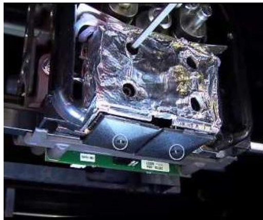
Figura 13. Vista del capçal amb doble extrusor d'una impressora 3D de tecnologia FDM de Stratasys. Font Treball de Doctorat Felip Fenollosa [B]
