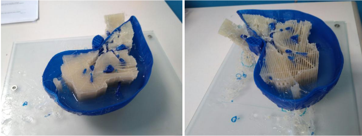
Figura 47. Producte fetge. En color blau, carcassa rígida de PLA. En color blanc, suports de PVA. En transparent, silicona. Font pròpia
