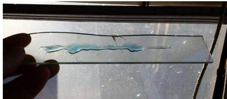
Figura 5. Resultats d'impressió del poliuretà amb la màquina del treball precedent. Font: Treball de final de carrera Alex López [A]
