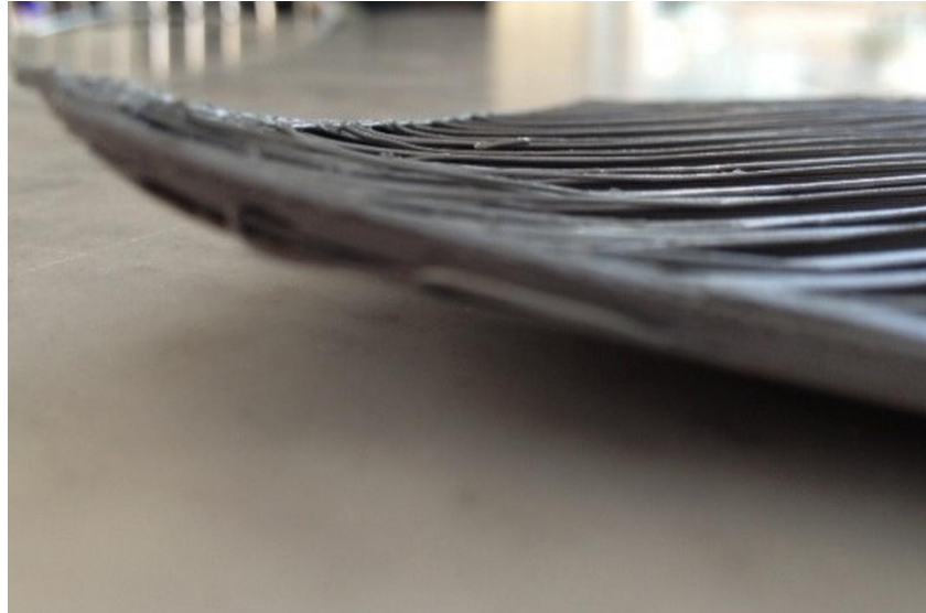
Figura 11. Warping. Problema associat a la contracció del material degut a la variació de temperatura. Font [2]
