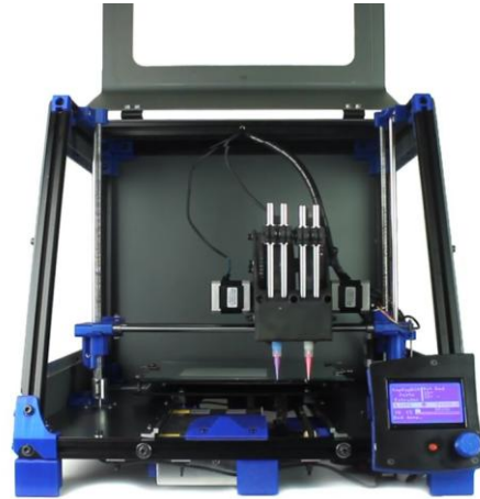
Figura 24. desenvolupament amb doble xeringa, per a recerca en pastes bimatèrials.. Font [1]
