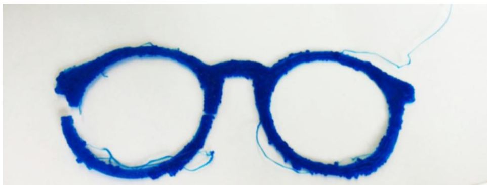
Figura 9. Producte rebutjat a causa d'un mal calibratge. Font pròpia
