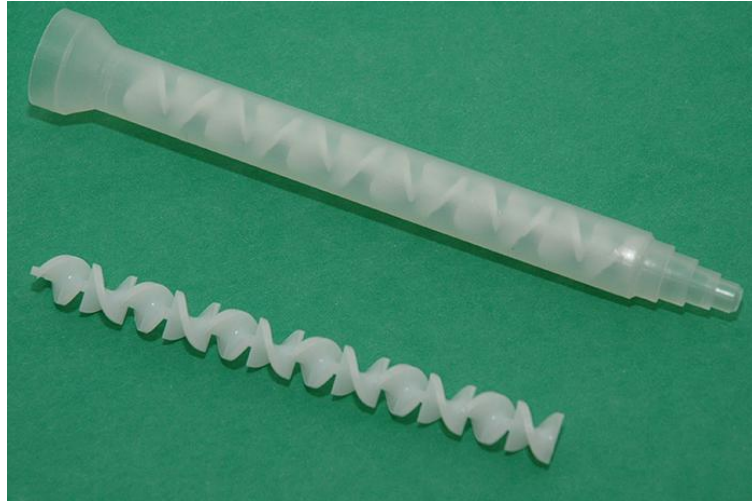
Figura 28. Cànula barrejadora d'un sol ús. En la part inferior de la figura es pot veure el camí tortuós que segueixen els fluids per barrejar-se. Font [10]
