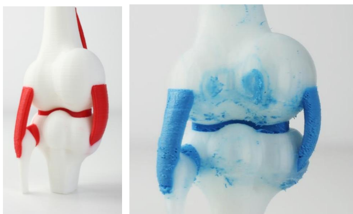
Figura 14. Peça feta amb bimatèrial. Dreta: feta amb impressora 3D de capçal amb doble extrusor, s'aprecia l'efecte del “oozing”. Esquerra: feta amb impressora 3D amb doble extrusor independent, els dos materials no han patit cap barreja. Font Treball de Doctorat Felip Fenollosa [B]
