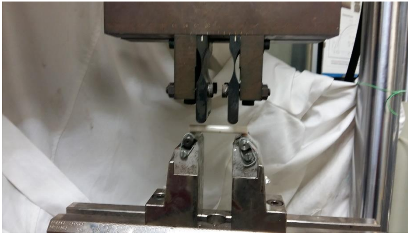
Fig. 29. Ensayo a flexión a 4 puntos realizado en los laboratorios de CIEFMA.
