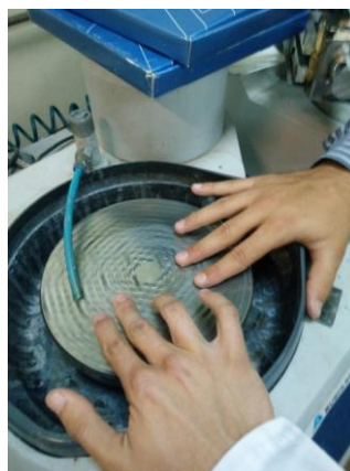
Fig. 17. Proceso de pulido con el paño MD550
