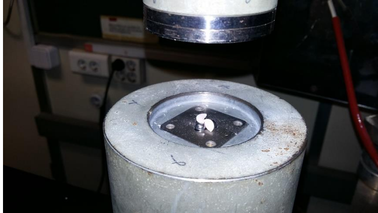
Fig. 32. Ensayo de flexión a 3 bolas habiendo cambiado el soporte de la máquina.
