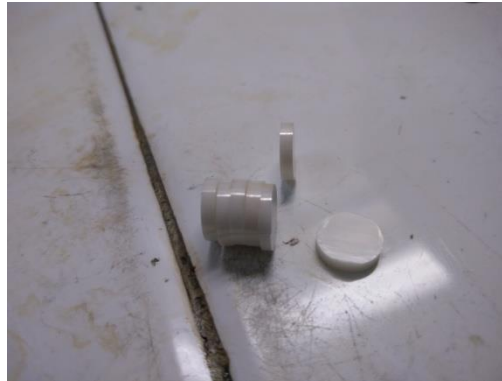
Fig. 16. Discos de zircona obtenidos a partir de las barras.
