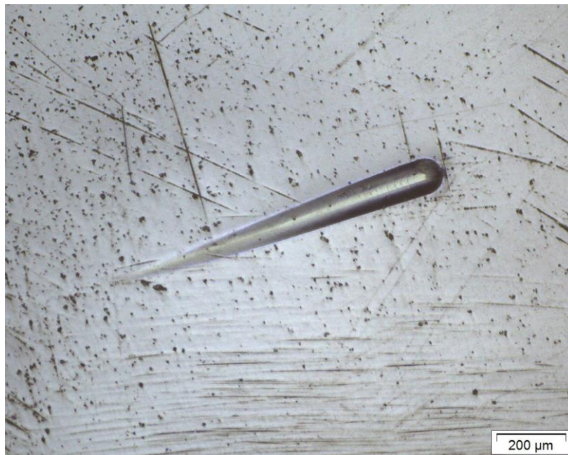
Fig. 55. Huella de scratch sobre probeta degradada y recocida.
