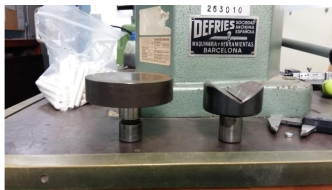
Fig. 20. A la izquierda: soporte utilizado para los discos. A la derecha: soporte utilizado para las barras.
