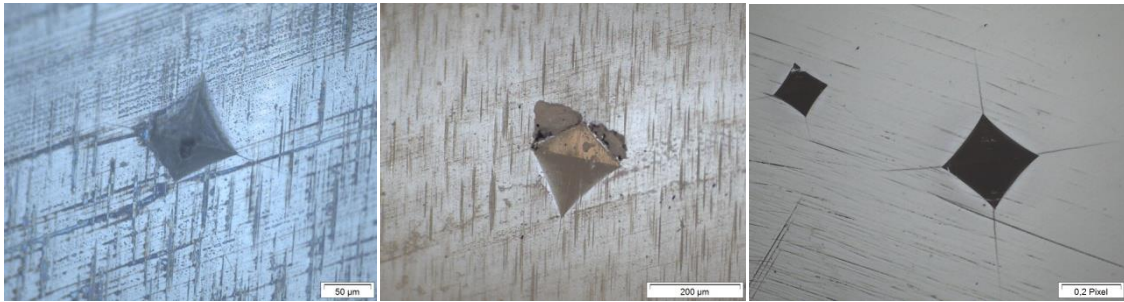
Fig. 21, 22 y 23. A la izquierda: indentación HV10 en una barra. En el centro: indentación HV30 en una barra. A la derecha: indentaciones HV10 y HV30 en un disco.
