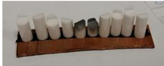
Fig. 40. Probetas sobre soporte preparadas para ser analizadas en el MEB.
