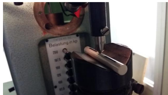
Fig. 19. Indentación de una barra de circona.
