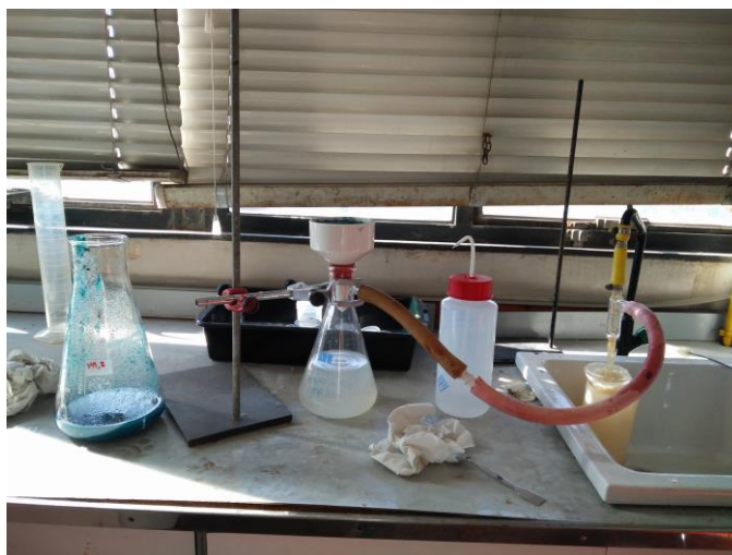
Imatge 17: Filtració al buit del \text{Cu}(\text{OH})_2
