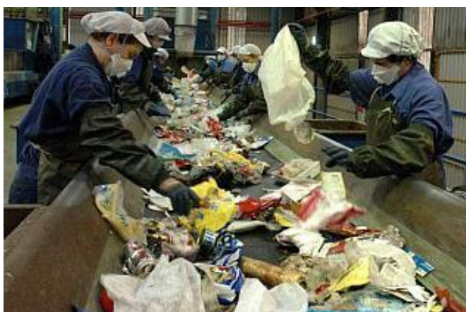
Figura 4.5. Separació dels plàstics mitjançant la classificació manual
