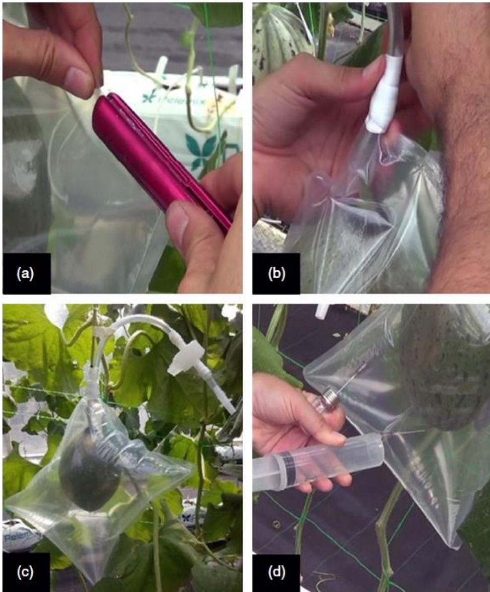
Figura 1: Mètode actual de recollida d'etilè : a) segellament del marge superior de la bossa de plàstic; b) segellament hermètic de la bossa junt amb el tub de plàstic i la tija de la planta del meló; c) bossa inflada amb el compressor; d) extracció de l'etilè acumulat dins la bossa passada 1h mitjançant una xeringa i un vial.
