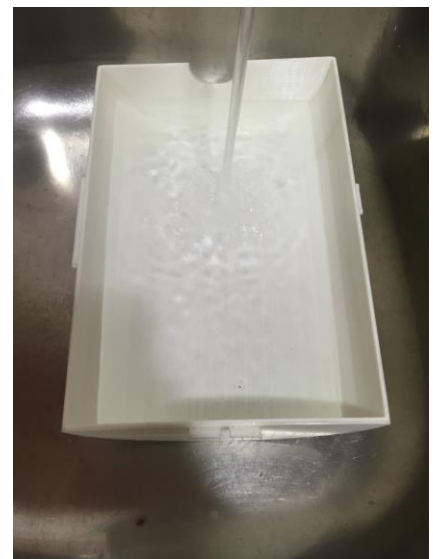
Figura 16: Prova d'estanqueïtat del prototip
