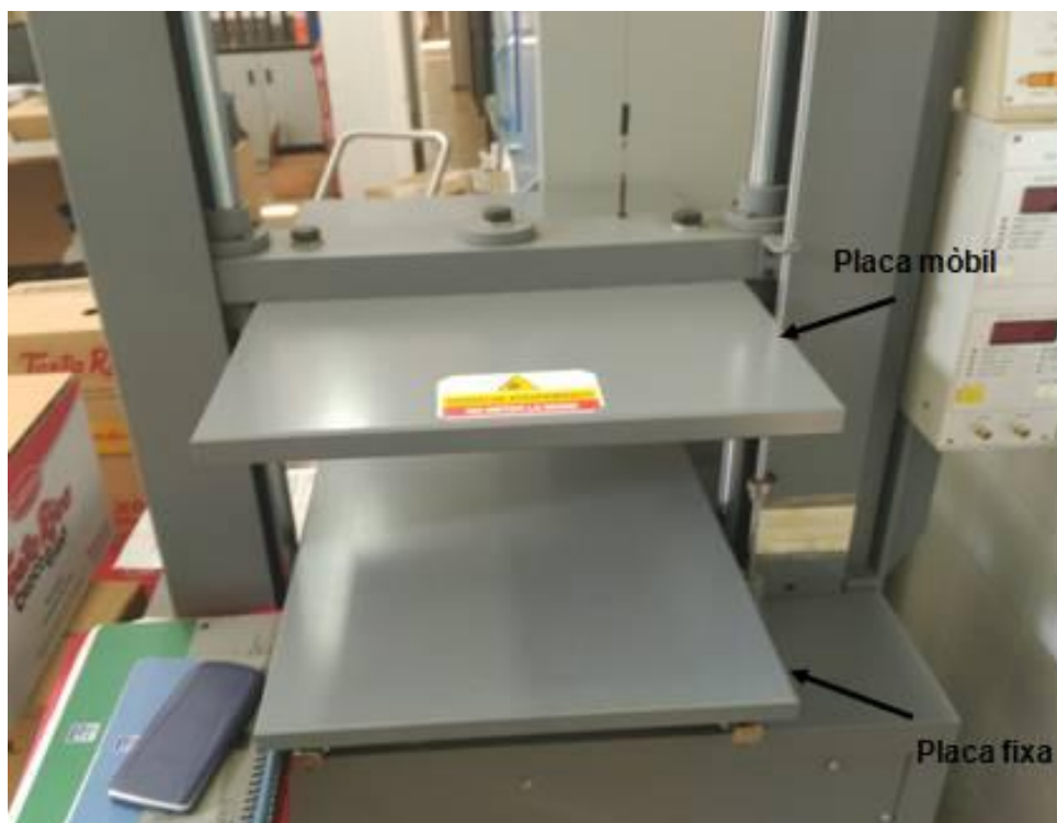
Figura 23: Màquina de compressió vertical
