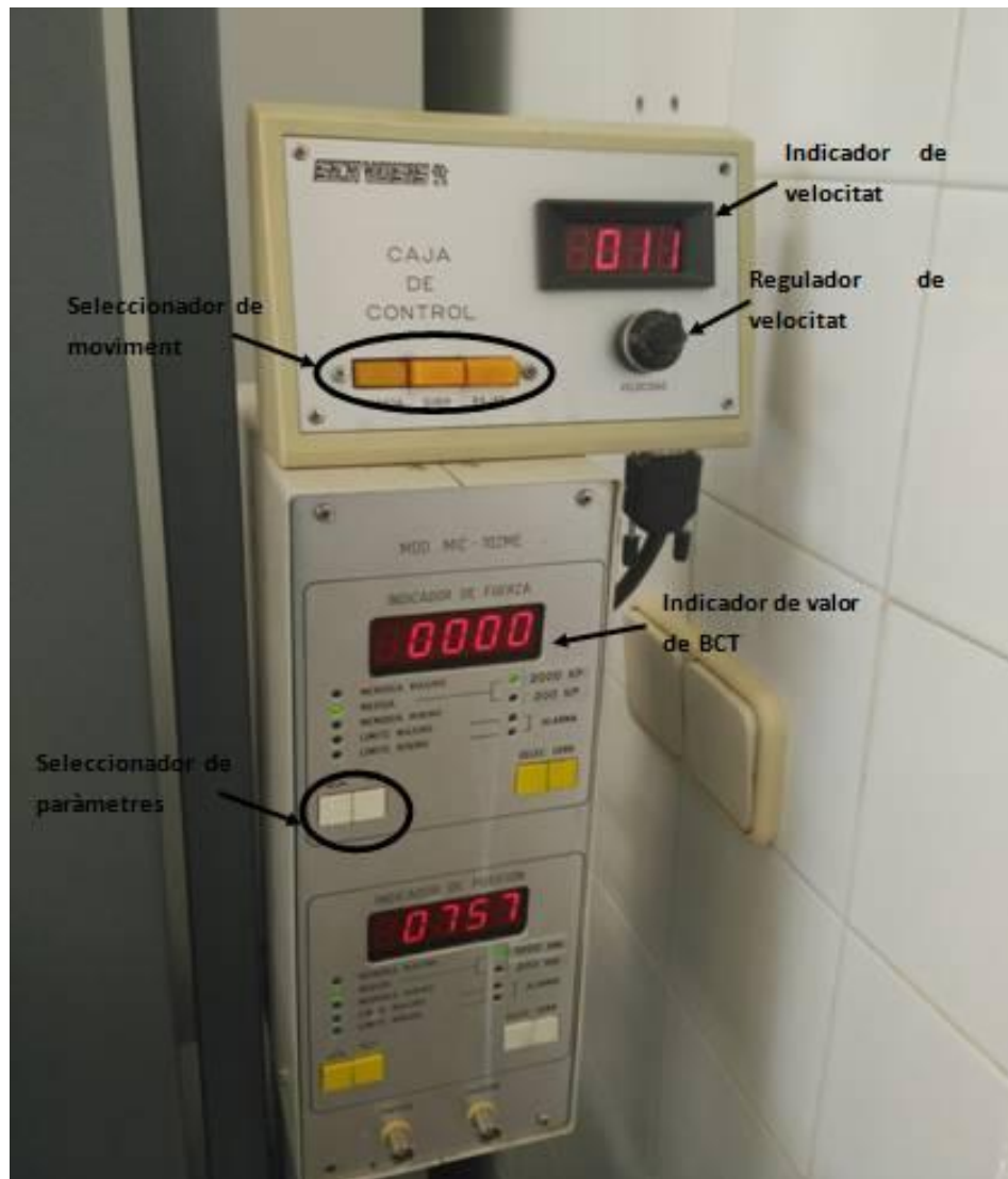
Figura 24: Comandaments de la maquinària
