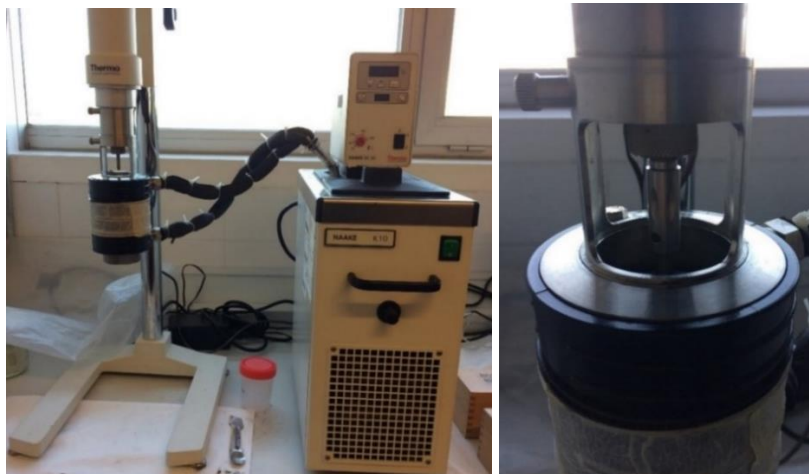
Figura 9. Aparell reòmetre HAAKE Viscotester.
