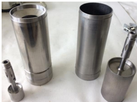
Figura 10. Sondes SV 2 (esquerra) i MV2 (dreta) del reòmetre.
