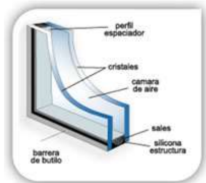
FIG. 40 - SECCIÓN DE UN VIDRIO CÁMARA. FUENTE: GRATOL
