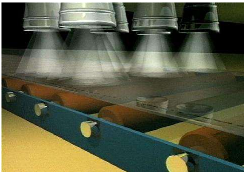
FIG. 36 - PROCESO DE FABRICACIÓN DE UN VIDRIO PIROLÍTICO. FUENTE: GRUPO CORBALÁN
