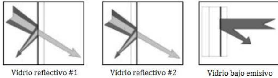
FIG. 37 - VIDRIO REFLECTIVO Y BAJO EMISIVO. FUENTE: MANUAL DEL VIDRIO PLANO.
