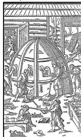
FIG. 3 - FUNDIENDO VIDRIO; GRABADO DE RE METALLICA, 12 LIBROS SOBRE MINERÍA Y METALURGIA, GEORGIUS ACRICOLA (1494-1555, BASEL, 1557)
