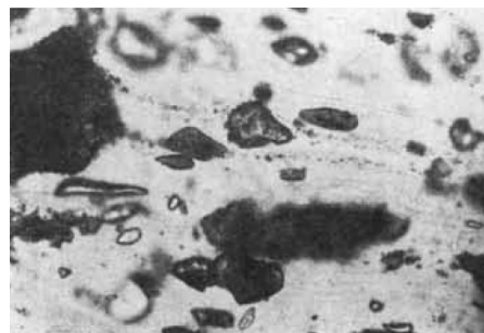
FIG 5 - GRANOS DE CORINDÓN (LUZ NORMAL, 60 AUMENTOS). FUENTE: COSME MONTES LÓPEZ (LABORATORIO CENTRAL DE CRISTALERÍA ESPAÑOLA S.A.).
