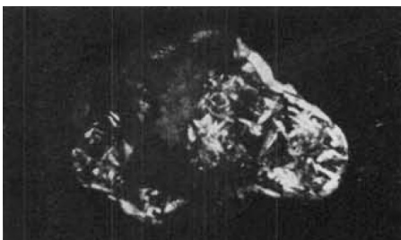
FIG 3 - GRANO DE SILIMANITA TRANSFORMADO EN EL INTERIOR DEL VIDRIO (LUZ POLARIZADA, 20 AUMENTOS). FUENTE: COSME MONTES LÓPEZ (LABORATORIO CENTRAL DE CRISTALERÍA ESPAÑOLA S.A).
