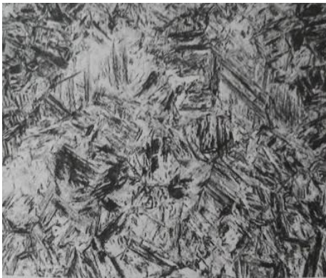
Fig 7.4. Martensita (x500) (CENIM)
