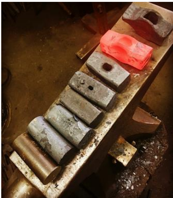
(Foto de Front Stef, colgada en su cuenta de instagram, de construcción de una herramienta de trabajo conformada mediante compresión y punzonamiento )
