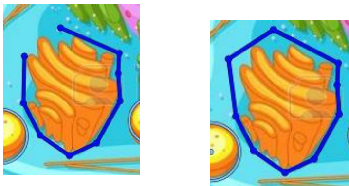
Fig. 9.6 Representació d'un component de tipus polygon (esquerra) i un altre de tipus poly (dreta)
