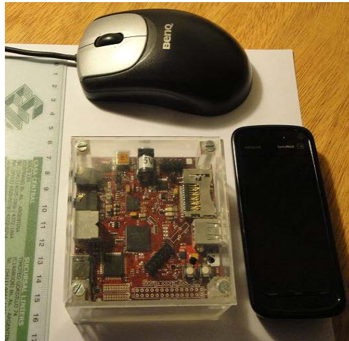
Fig. 1. Dimensiones de la unidad de control y procesamiento. La placa Beagleboard se encuentra localizada en el interior de una caja de acrílico diseñada a medida.
