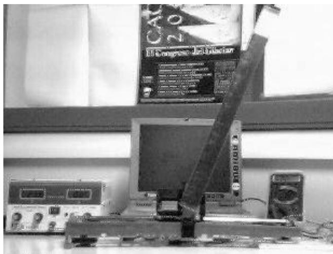
Fig. 9 - Sistema físico que implementa al péndulo invertido
