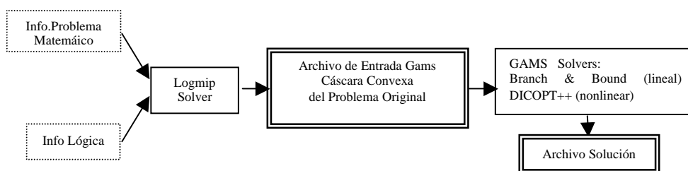
Fig. 10. Diagrama de flujos en la resolución de un problema disyuntivo/híbrido
