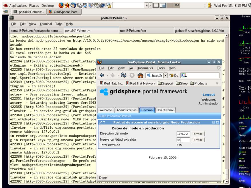
Figura 2: Visualización del portlet `NodoProducPortlet` en el portal GridSphere. De fondo se encuentra una consola donde se monitorea el log del Apache-Tomcat, en la parte superior de este se puede observar como el portlet reporta su actividad.
