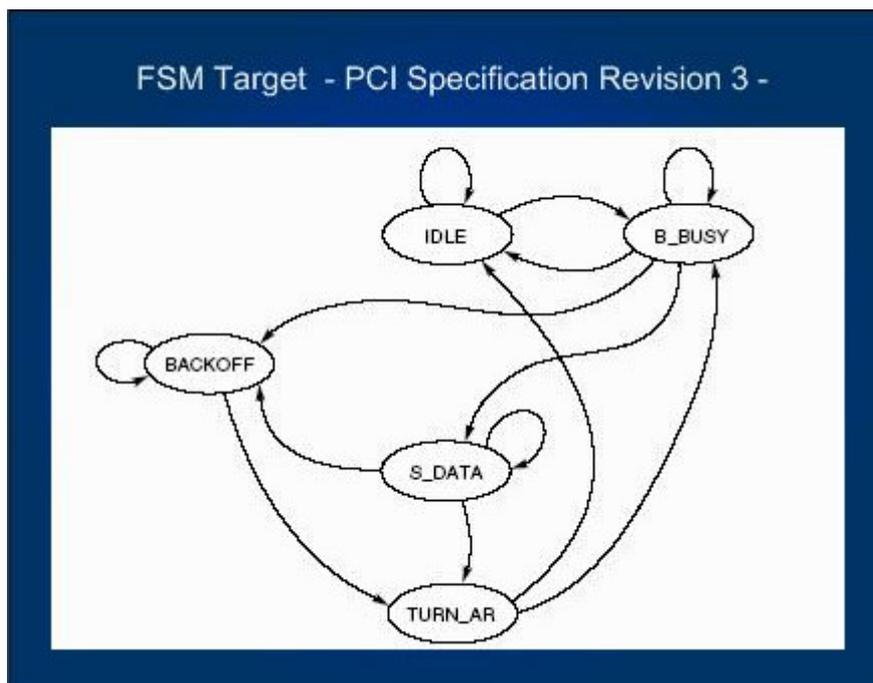
Figura 3: FSM sugerida por PCI Specification Revision 3.
