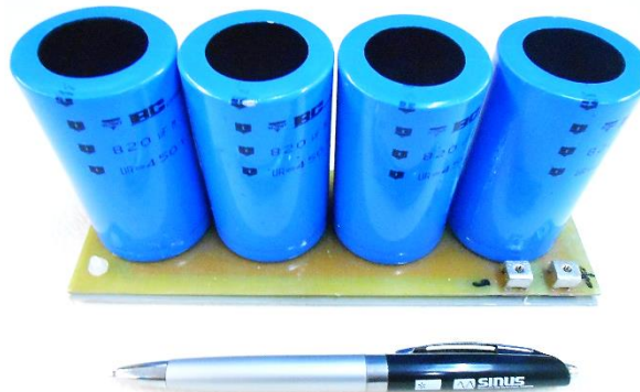
Figura 5.8 – Condensadores utilizados para o barramento CC do conversor CC-CA.
