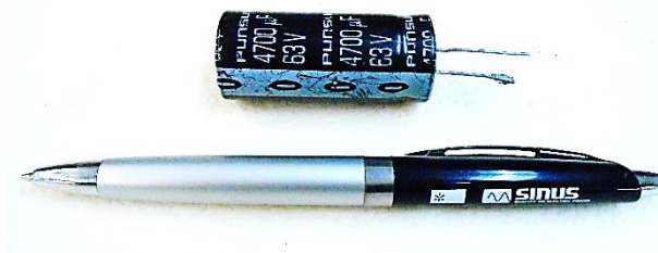
Figura 5.13 – Condensador utilizado para filtragem da corrente nas baterias.
