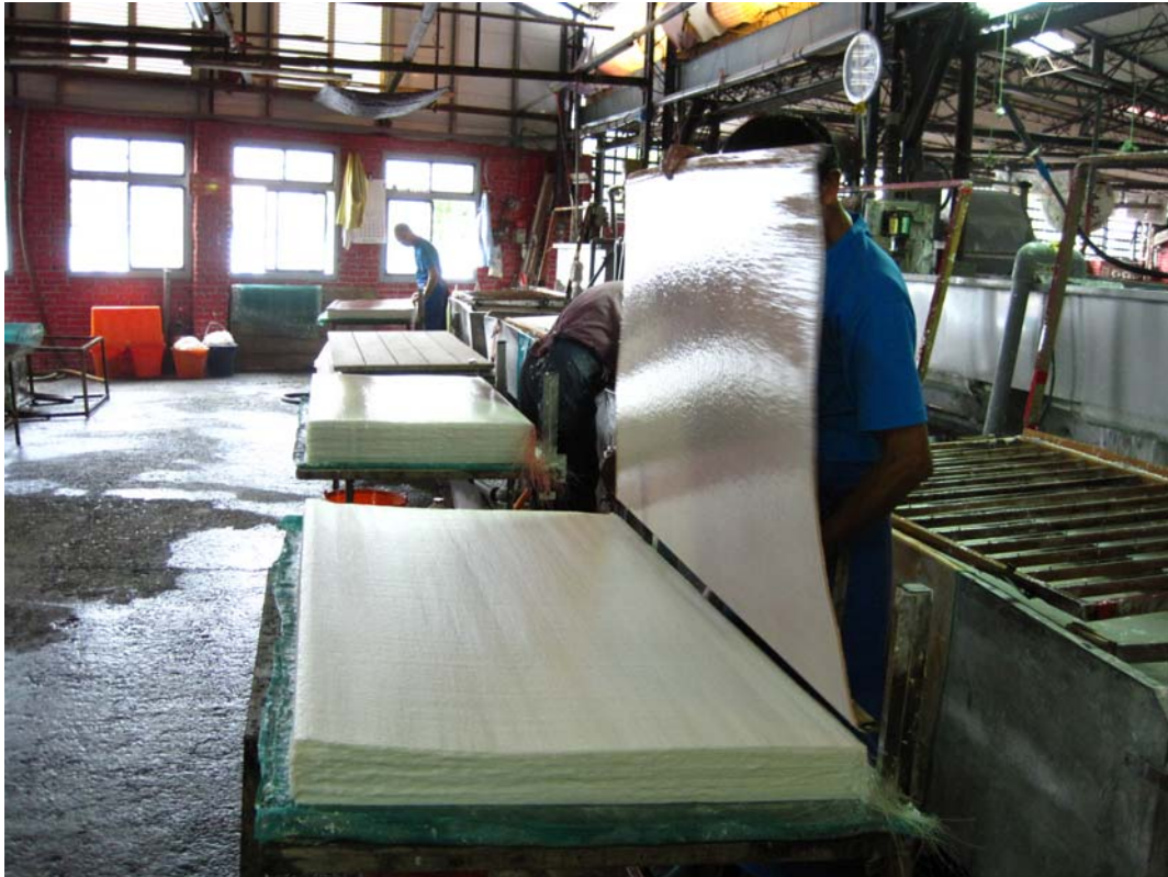
87. Levantar la malla y volverse hacia los papeles mojados apilados, y después de alinear la malla por el lado izquierdo, ponerla despacio en dirección vertical para abajo.
