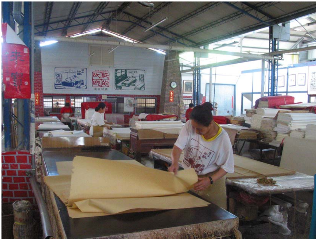
94. Una vez secado el papel, se debe recoger y apilarse.
