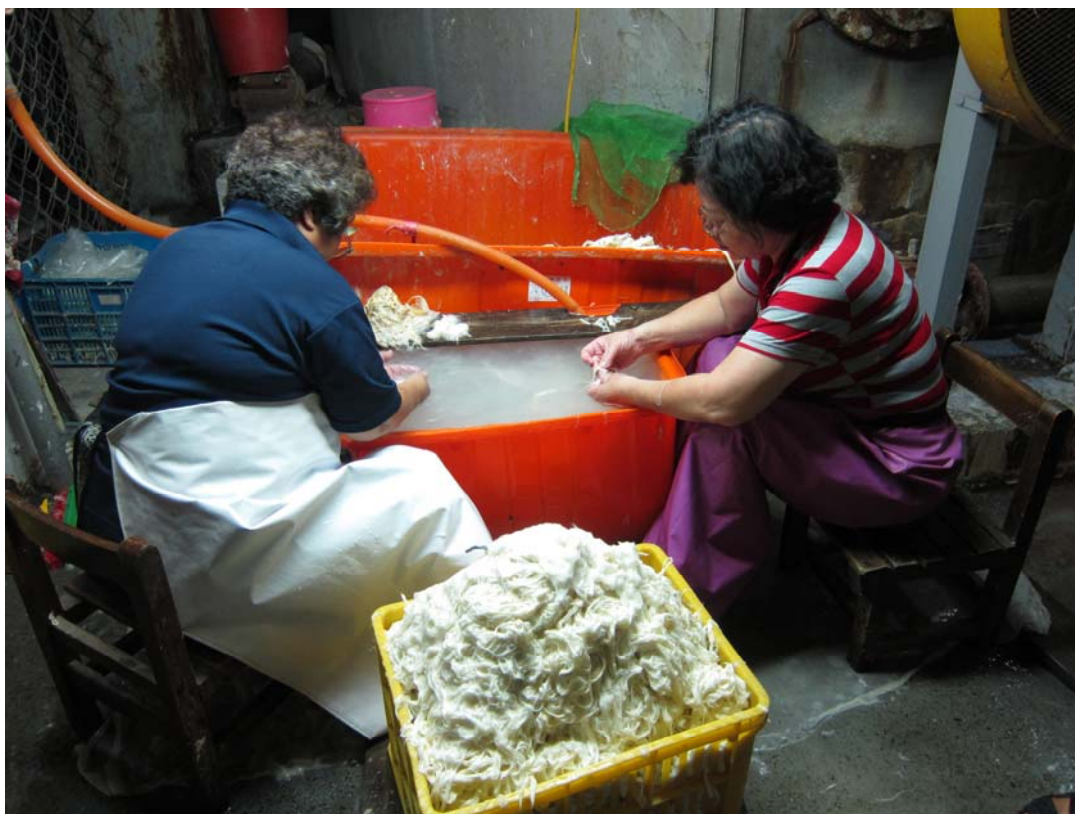
73. Eliminar las impurezas. Quitar las cáscaras duras y las impurezas.
