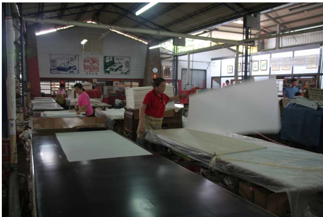
91. Levantar el palo, y enrollar suavemente el papel.
