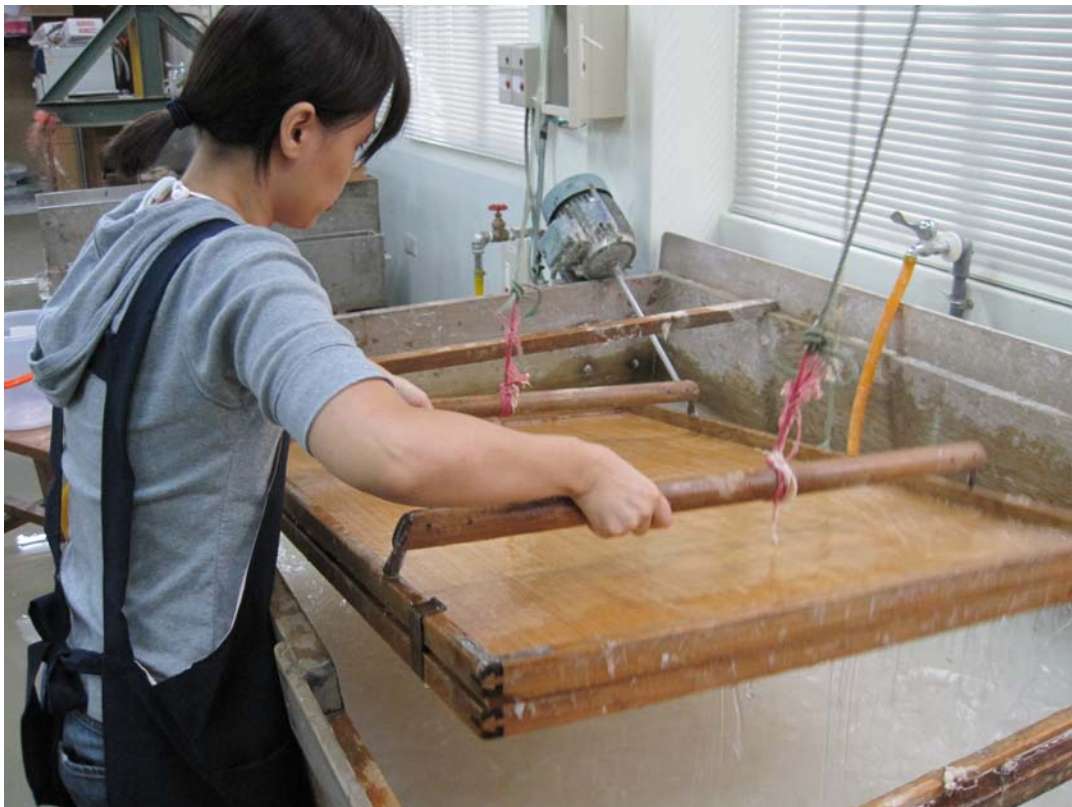
79. Se pone delante de la cisterna, y se mantiene el marco de la formación de la hoja, apartando, y con este mismo apartando las barras de madera que lo sostiene abajo.
