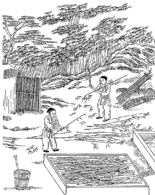
61. Cortar el bambú y remojarlo en el estanque.
