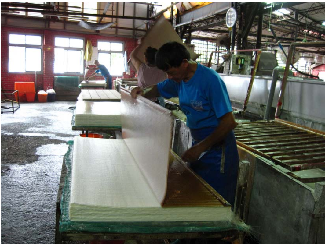
88. La malla debe formar un ángulo recto con los papeles amontonados. Esto sirve para que el aire no pase entre los papeles, produciendo burbujas, que estropearían el conjunto de papel durante el proceso de prensar el mismo. Esta manipulación requiere mucha experiencia y destreza.
