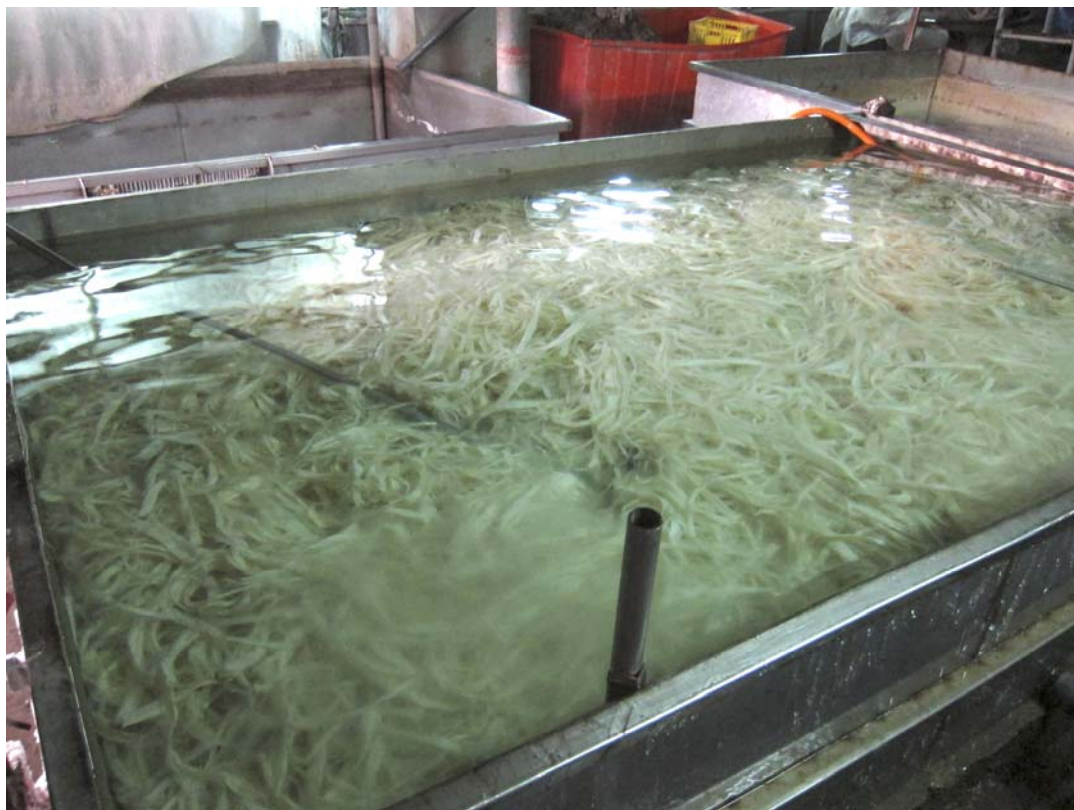
70. Fibras remojadas en la solución blanqueadora.
