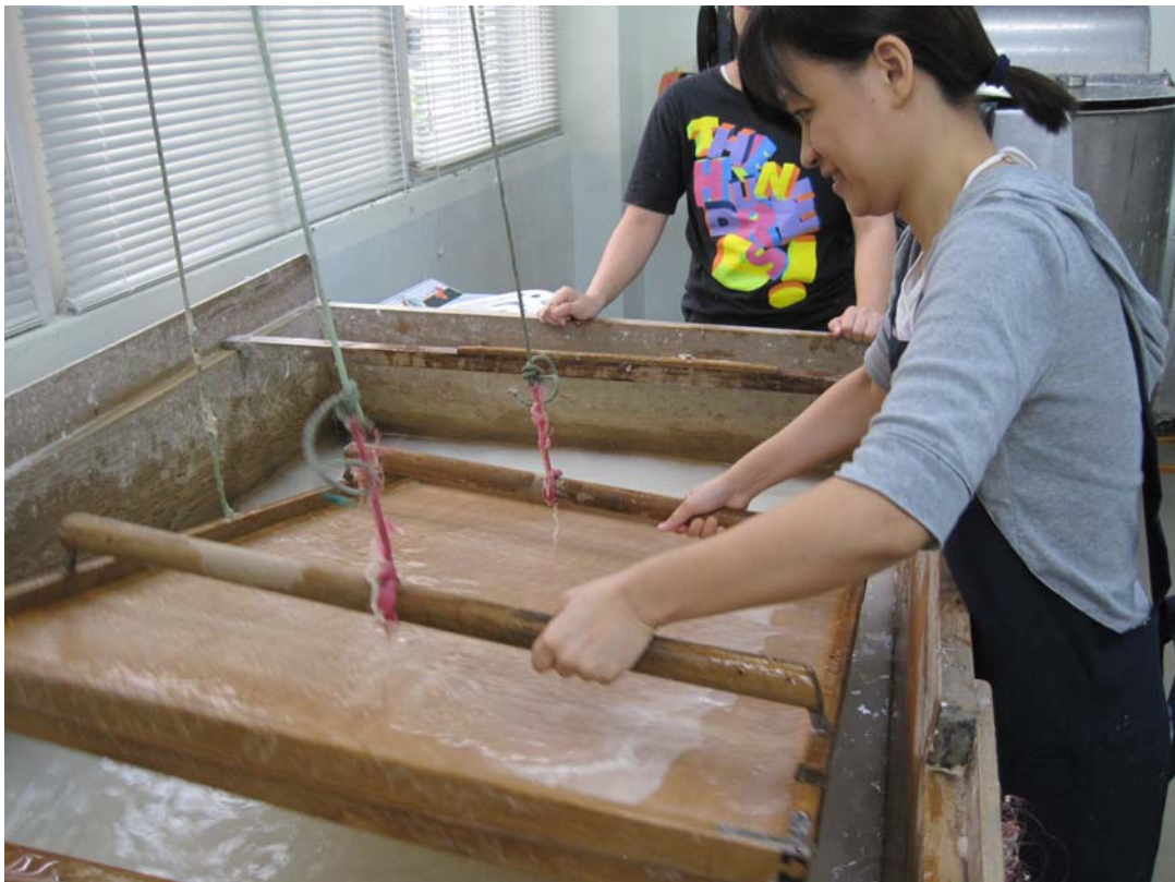
82. Con el marco sostenido por las cuerdas que conectan los agarraderos de éste y los palos de bambú, es menos laboriosa la agitación del marco.
