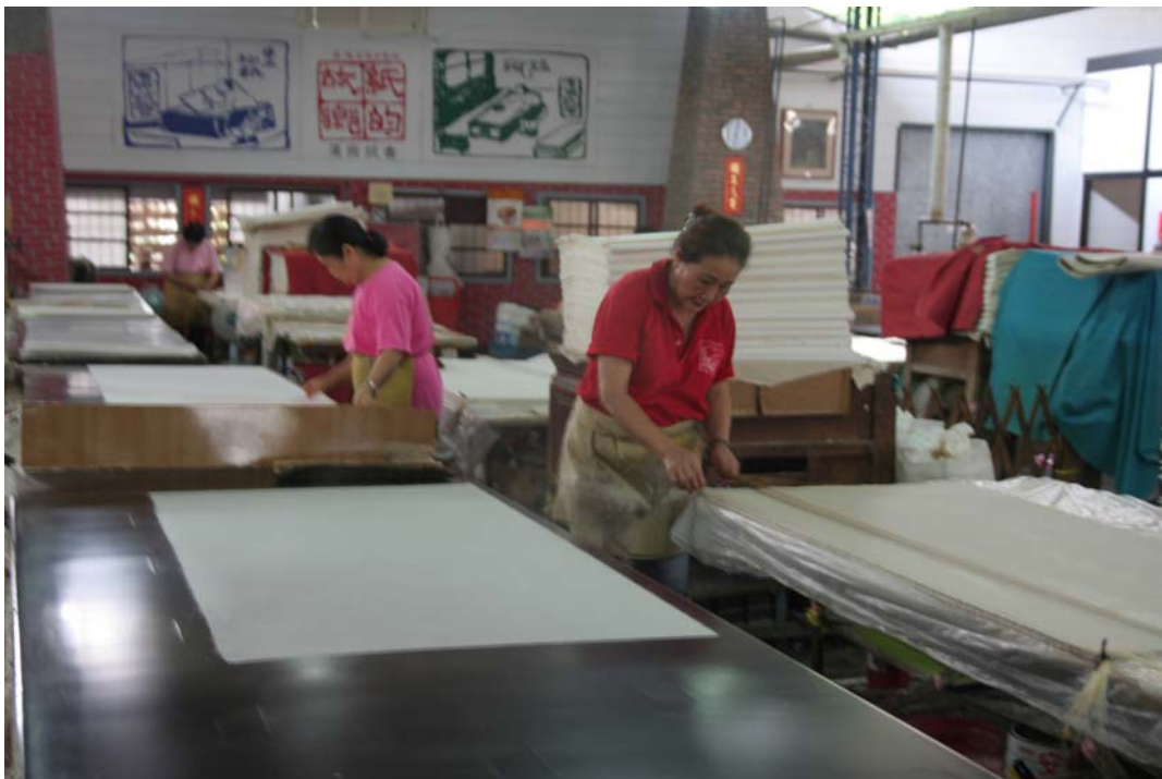
90. Poner un palo a lo largo del hilo de nailon, levantar el hilo y dejar que el costado de un papel levantado por el hilo cubra el palo.
