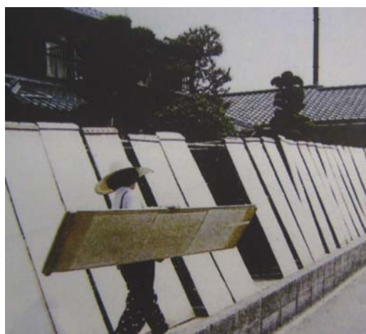
48. Las hojas de papel, pegadas a las tablas de madera, para secarse por el sol.
