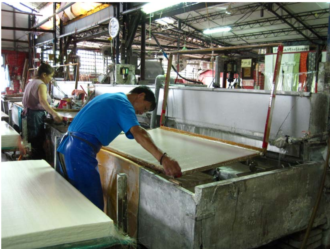
86. Abrir el marco y apretar un hilo de nailon al lado de la malla.
