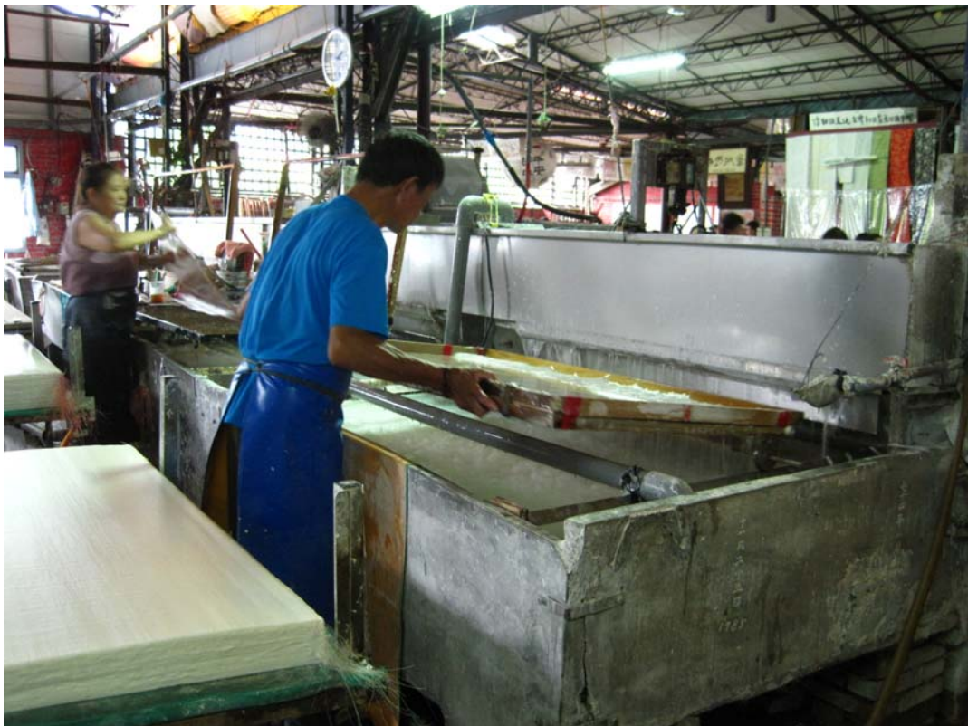
84. Se levanta el marco y se agita suavemente, extendiéndose así la fibra de la pulpa de forma entrelazada. Dentro del marco, hay una malla, por encima de la que se quedará la pulpa de celulosa.
