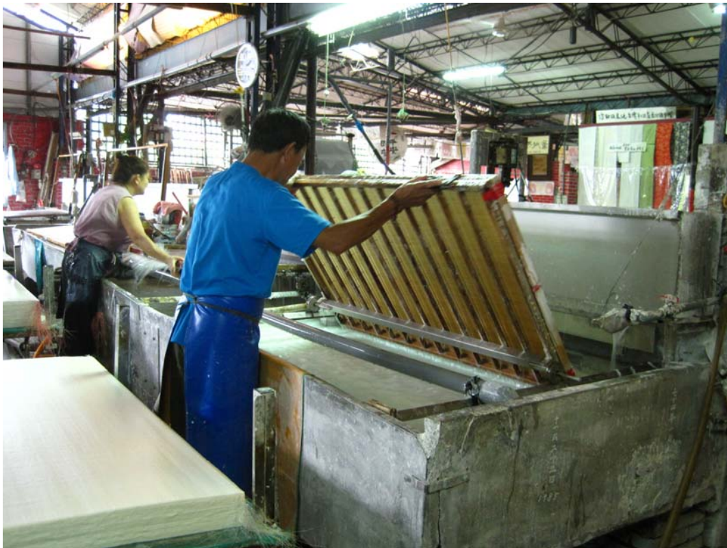
85. Filtrar el agua de sobra.
