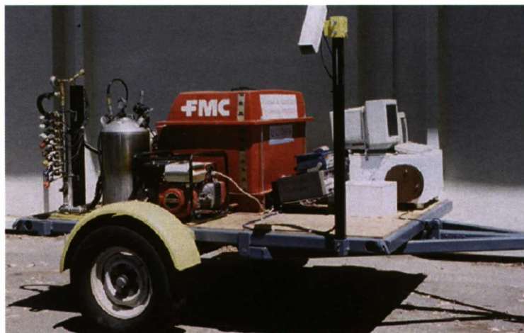
Foto 6. Prototipo inicial del sistema inteligente de aplicación.
