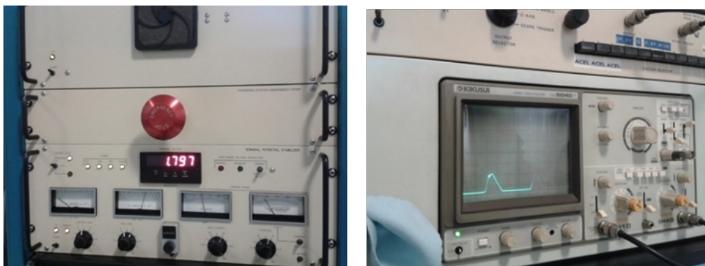
Figura 3.16: Instrumentación en sala de control del acelerador. Izq.: panel de ajuste del voltaje del acelerador. Der.: monitorización del perfil de haz.
