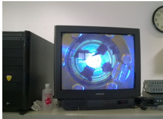
Figura 3.18: Imagen del haz impactando en la view-port , transmitida por CCTV a un monitor situado en la sala de control.
