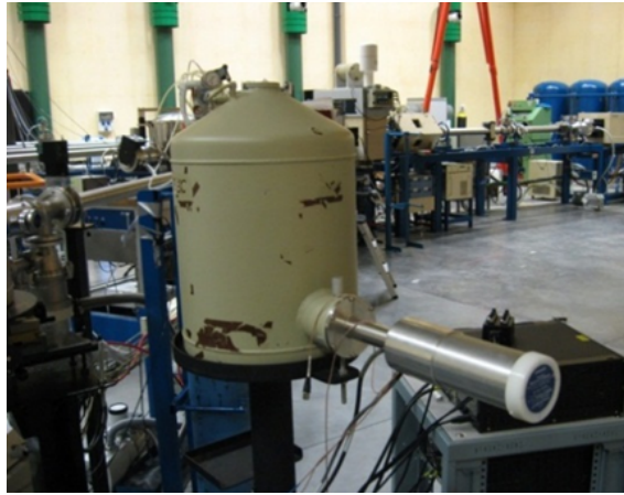
Figura 3.12: Fotografía del detector gamma HPGe Ortec GMX 35195-S con tanque de nitrógeno líquido para refrigeración utilizado en ambas activaciones.
