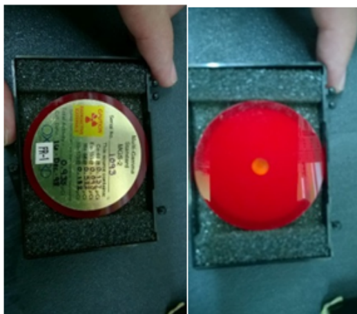
Figura 4.19: Fuente de referencia utilizada para la calibración. A la derecha se puede observar en la zona central el hueco donde está depositado el material radioactivo.
