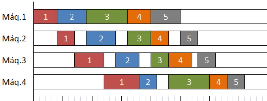
Figura 1.3 – Diagrama de Gantt resultado de la secuencia  $\pi=\{1,2,3,4,5\}$  para un PFSP sin más restricciones, con los tiempos de proceso de la tabla 1.1 (Elaboración propia)
