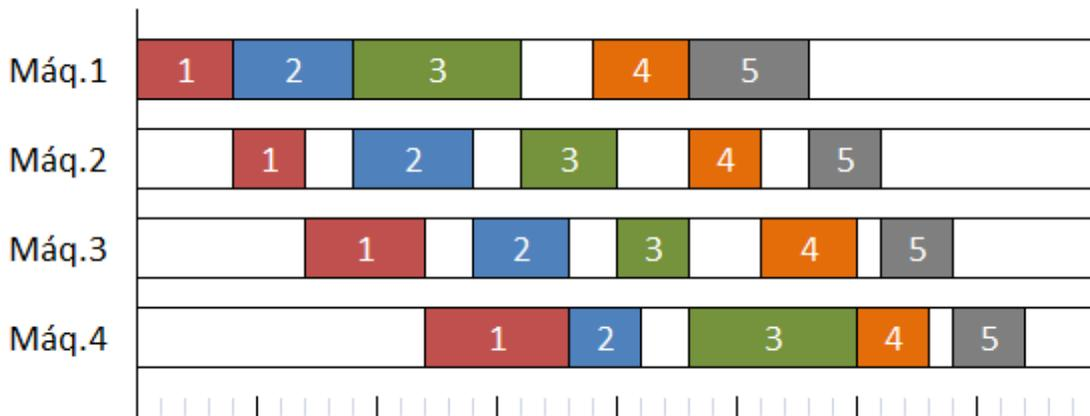
Figura 1.4 – Diagrama de Gantt resultado de la secuencia  $\pi=\{1,2,3,4,5\}$  para un PFSP con restricción *no-wait*, con los tiempos de proceso de la tabla 1.1 (Elaboración propia)
