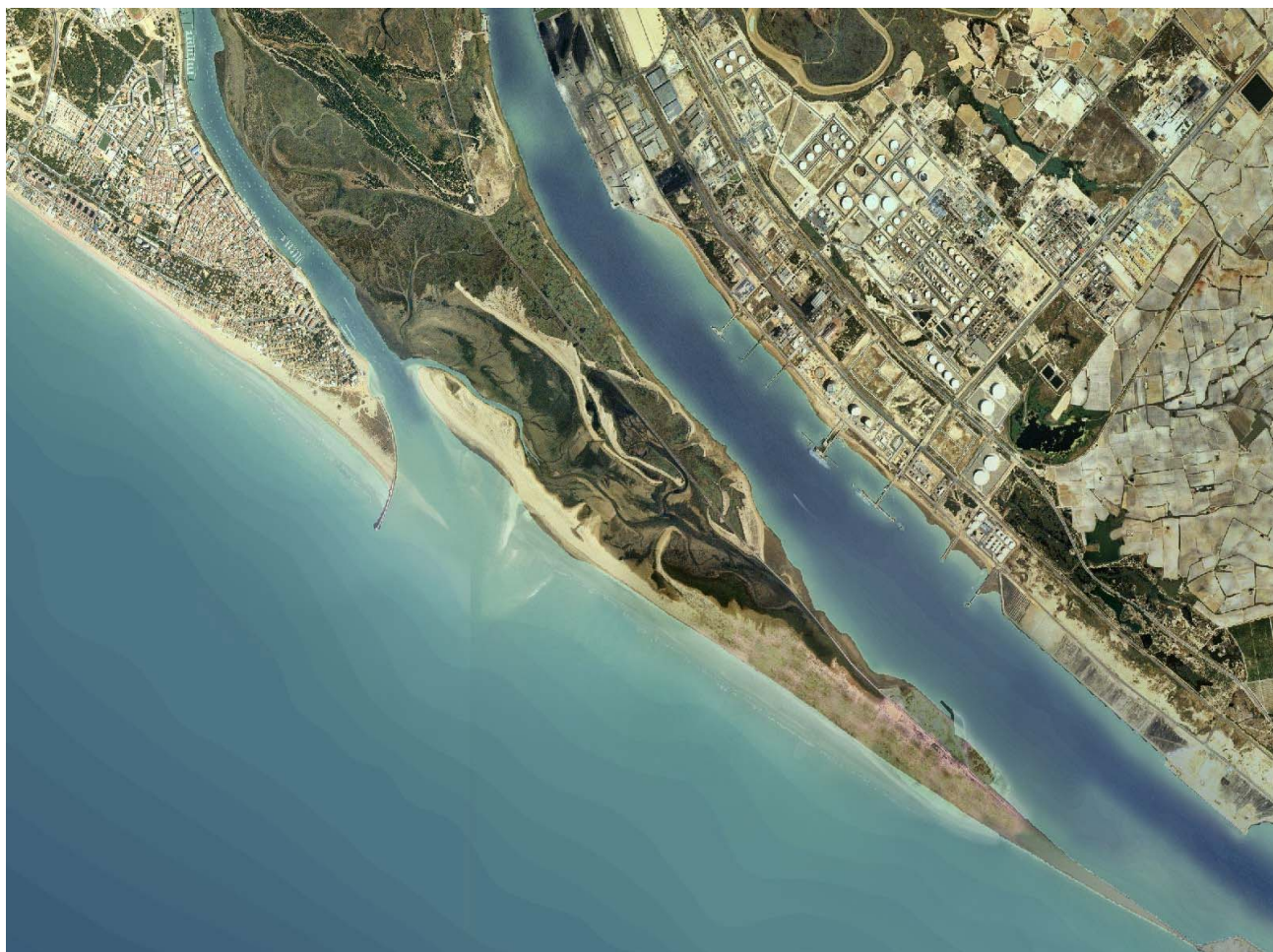
Figura 11. Utilización del MDE como máscara para la edición de ortofotos. Sector de Punta Umbria y Canal de acceso al estuario del Tinto-Odiel. La precisión geométrica de la línea de costa utilizada en la interpolación permite un perfecto ajuste de la máscara y la utilización de transparencias en los niveles batimétricos más próximos a ella garantiza un adecuado tratamiento visual de los bajos intermareales.
