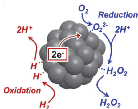
Figura 1.12 Esquema del mecanismo de reacción en la síntesis directa de peróxido de hidrógeno sobre un catalizador metálico. 118
