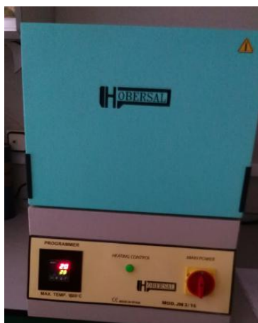
Figura 6. Horno tipo mufla empleado para los tratamientos térmicos.
