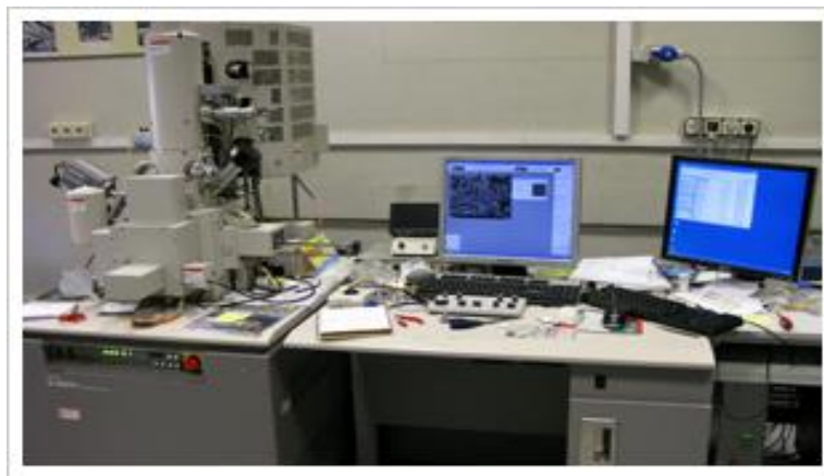
Figura 9. Microscopio electrónico de barrido (SEM) del modelo Hitachi S4800 SEM-FEG utilizado para caracterizar las muestras.
