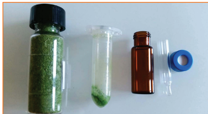
FIGURA 5. Muestra liofilizada de vegetal foliáceo, extracto seco sin saponificar y vial e inserto usados para la inyección en el equipo cromatográfico.
