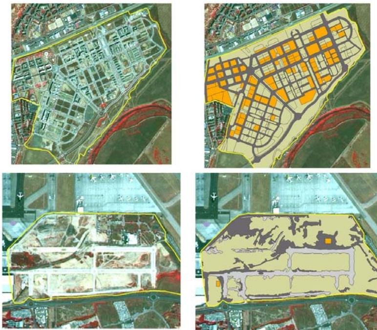
**Figura 5.** Ejemplos de Clasificación orientada a objetos con catastro adecuado (imagen superior) y no adecuado (imagen inferior), sobre imagen SPOT5 fusionada 2.5m.
