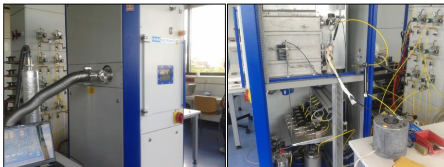
Figura A.1. (a) Equipo de PECVD (b) Lateral del equipo, donde se observa la cinta calefactora cubriendo el recipiente del precursor, y los distintos gases conectados al sistema.
