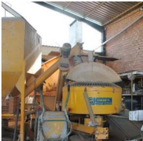
Figura 94 Proceso Productivo. Mezcladora. Fuente: Solbloc
