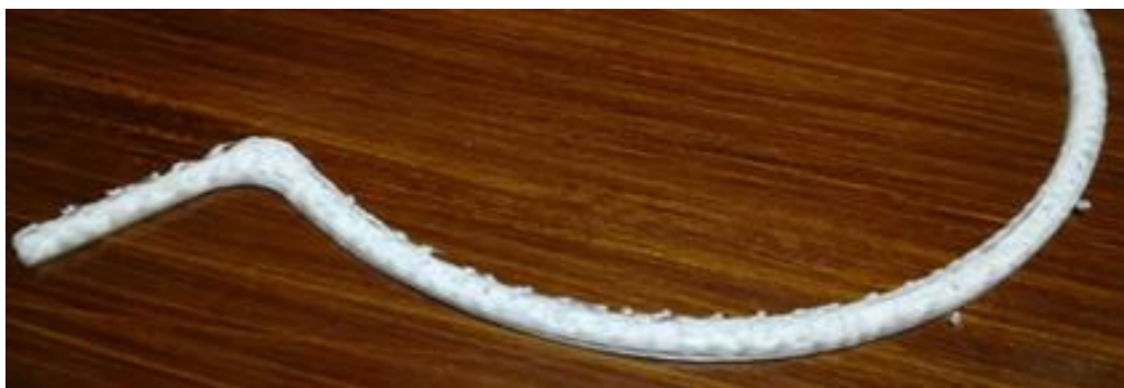
Figura 50 Error en la Extrusión debido a estrechez de las Paredes
