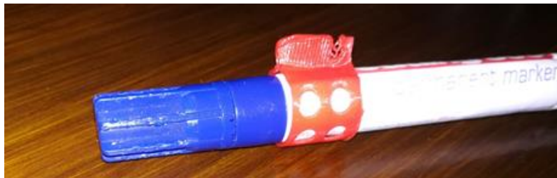
Figura 35 Férula 3D de PLA adherida en Rotulador
