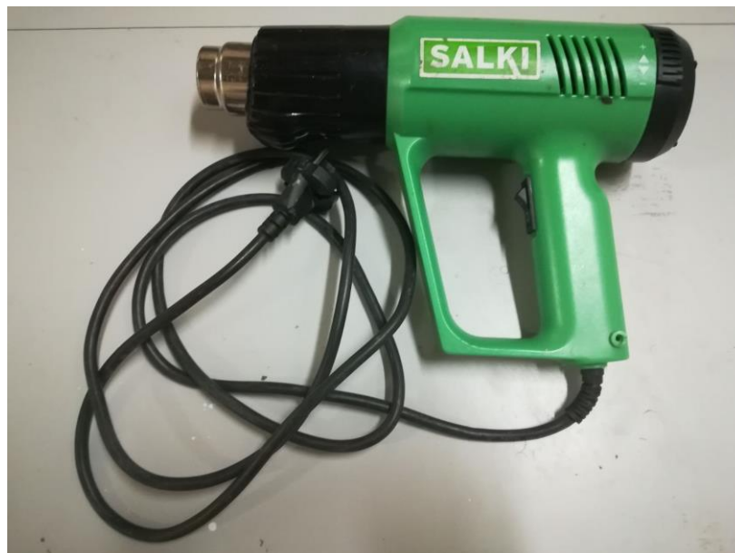
Figura 64 Secador Industrial Salki utilizada para aplicar calor al modelo
