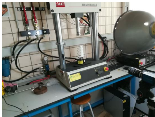
Figura 60 Máquina Mini Bionix II, ensayo PLA
