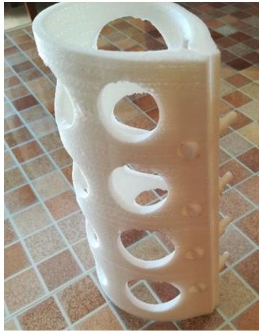
Figura 55 Férula con altura capa 0,1mm
