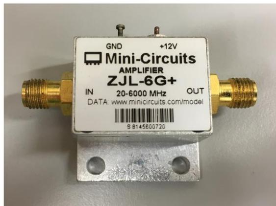
Figura 7-1. Amplificador de potencia ZJL-6G+.
