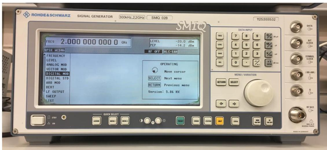
Figura 5-2. Generador de señal.
