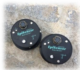
Figura 5.13. Acelerómetros usados en el ensayo de vibración ambiental. Fuente: Elaboración propia.
