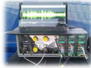
Figura 5.14. Unidad central de adquisición usada en el ensayo. Fuente: Elaboración propia.
