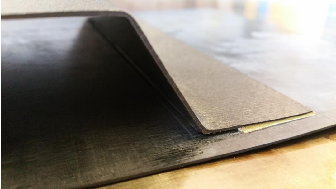
Figura 3-13. Probeta con defecto de pegado
