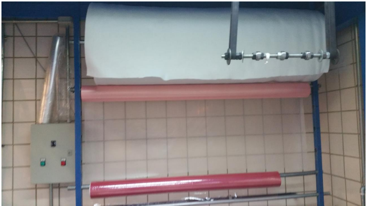
Figura 3-5. Tejido aireador, plástico y lámina desmoldeante
