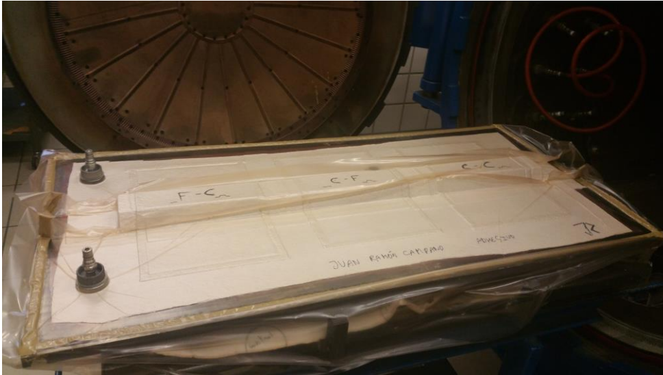
Figura 3-11. Bolsa completa con tres moldes, placas y doble tejido
