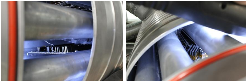
Figura 64. Colocación de probetas en el interior del SAC.
