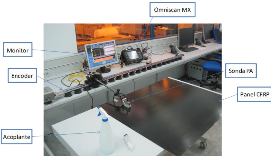
Figura 54. Montaje para la inspección mediante ultrasonidos phased array sobre paneles planos.
