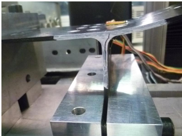
Figura 125. Rotura probeta EVAPT01.
