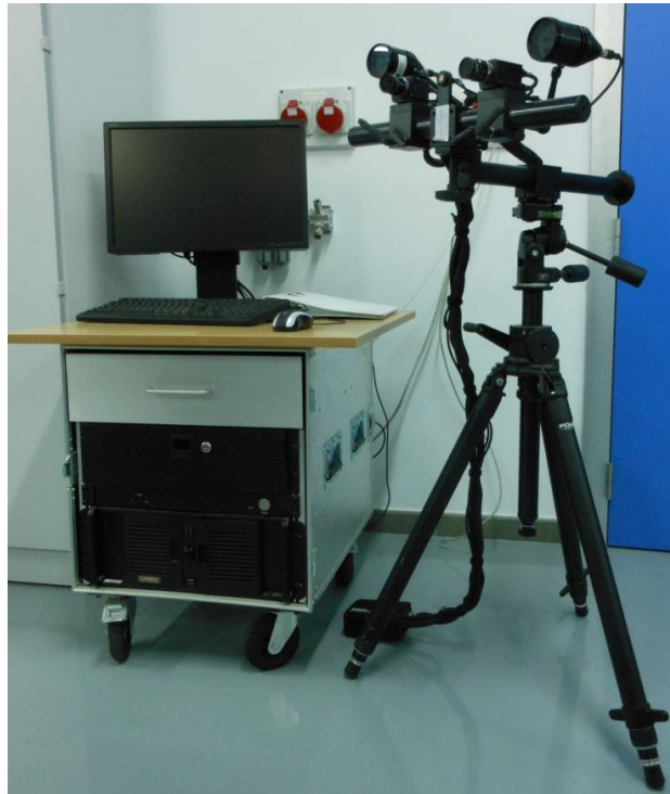
Figura 45. Equipo PONTOS-5M para medición de desplazamientos.
