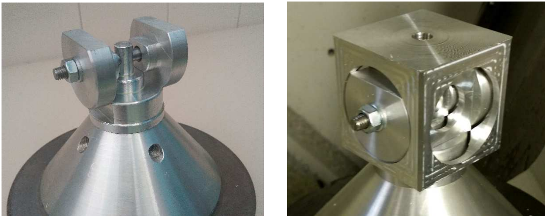
Figura 122. Utillaje diseñado y montado en pieza intermedia
