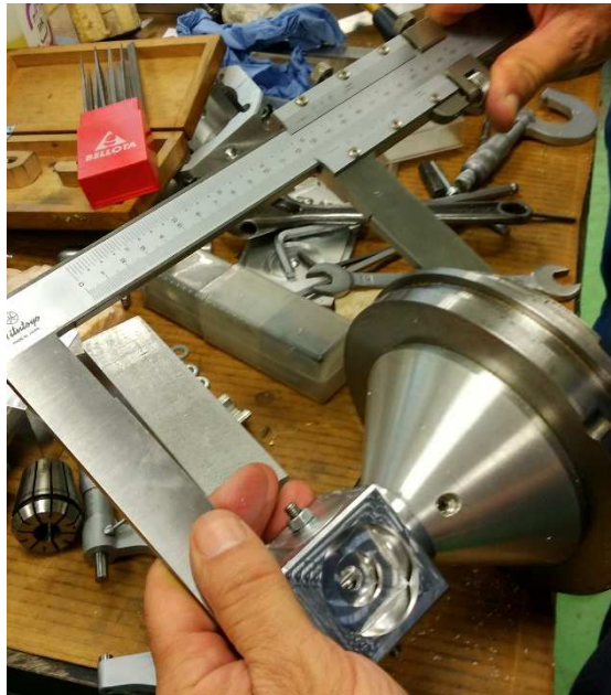
Figura 123. Medición posición cero pieza en amarre B
