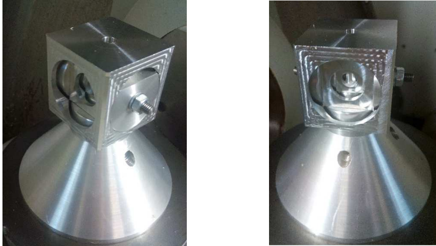
Figura 125. Pieza intermedia montada en amarre B
