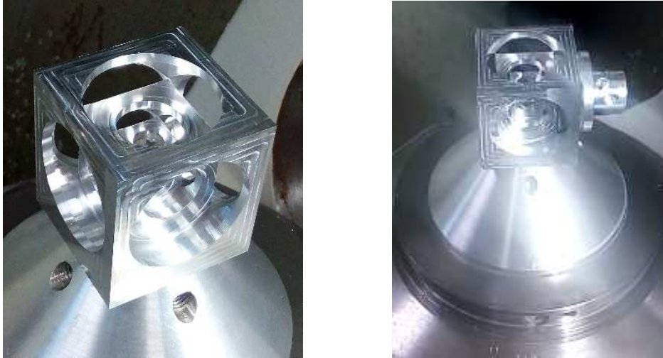
Figura 120. Pieza rectificada con y sin cuerpo del útil montado en un lateral
