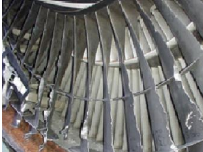
Figura 2.2: Ejemplo de erosión ( http://mecmex.com/recubrimientos-abrasibles/ )
