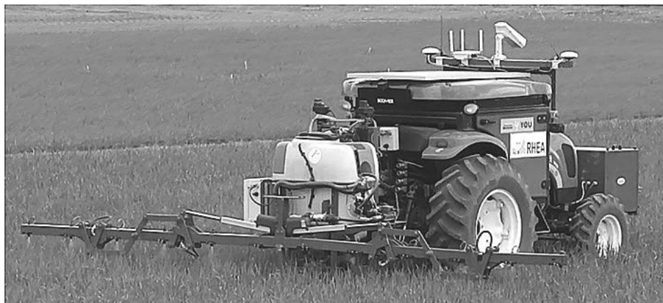
Figura 5. Equipo autónomo para la aplicación localizada de herbicida (Proyecto RHEA- www.rhea-project.eu ).
