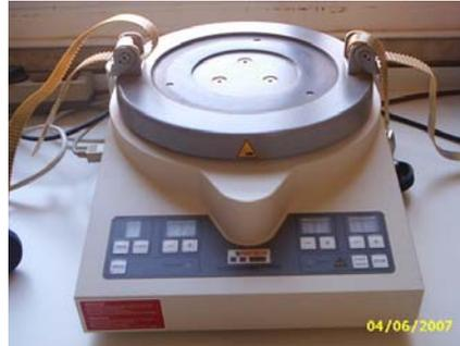
**Foto III.9.** Detalle de tamizadora electromagnética FRITSCH Analysette 3 PRO.
