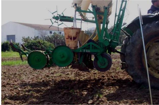
**Foto III.4.** Sembradora utilizada para la siembra del girasol.
