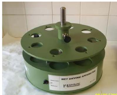
**Foto III.10.** Aparato de Yoder Ejkelkamp utilizado para la determinación de la EAh.
