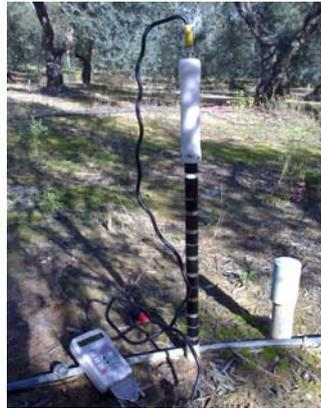
**Foto III.11.** Sonda Profile Probe.
