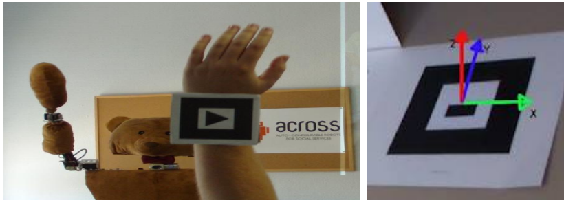
Fig. 3 Imágenes de etiquetas de realidad aumentada utilizadas para la detección del movimiento por parte del primer prototipo de plataforma robótica.
