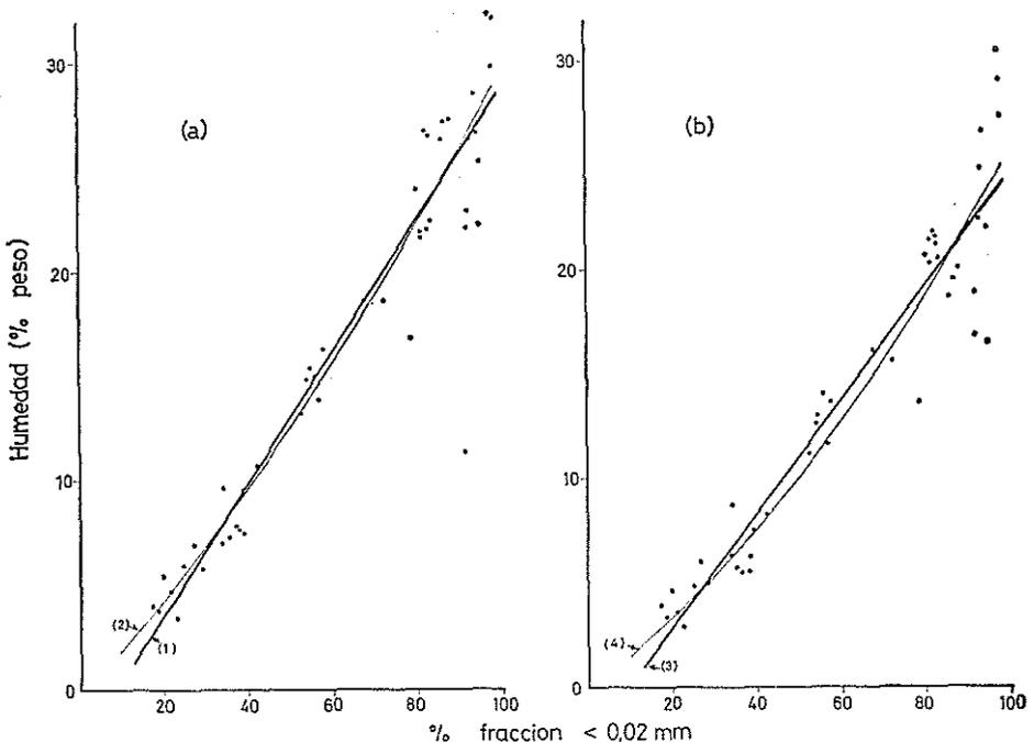
Fig. 1.—Regresiones lineales [(1) y (3)] y parabólicas [(2) y (4)] entre el contenido de la fracción < 0,02 mm. y el contenido de humedad a pF 4,2 (a) y pF 4,6 (b).
