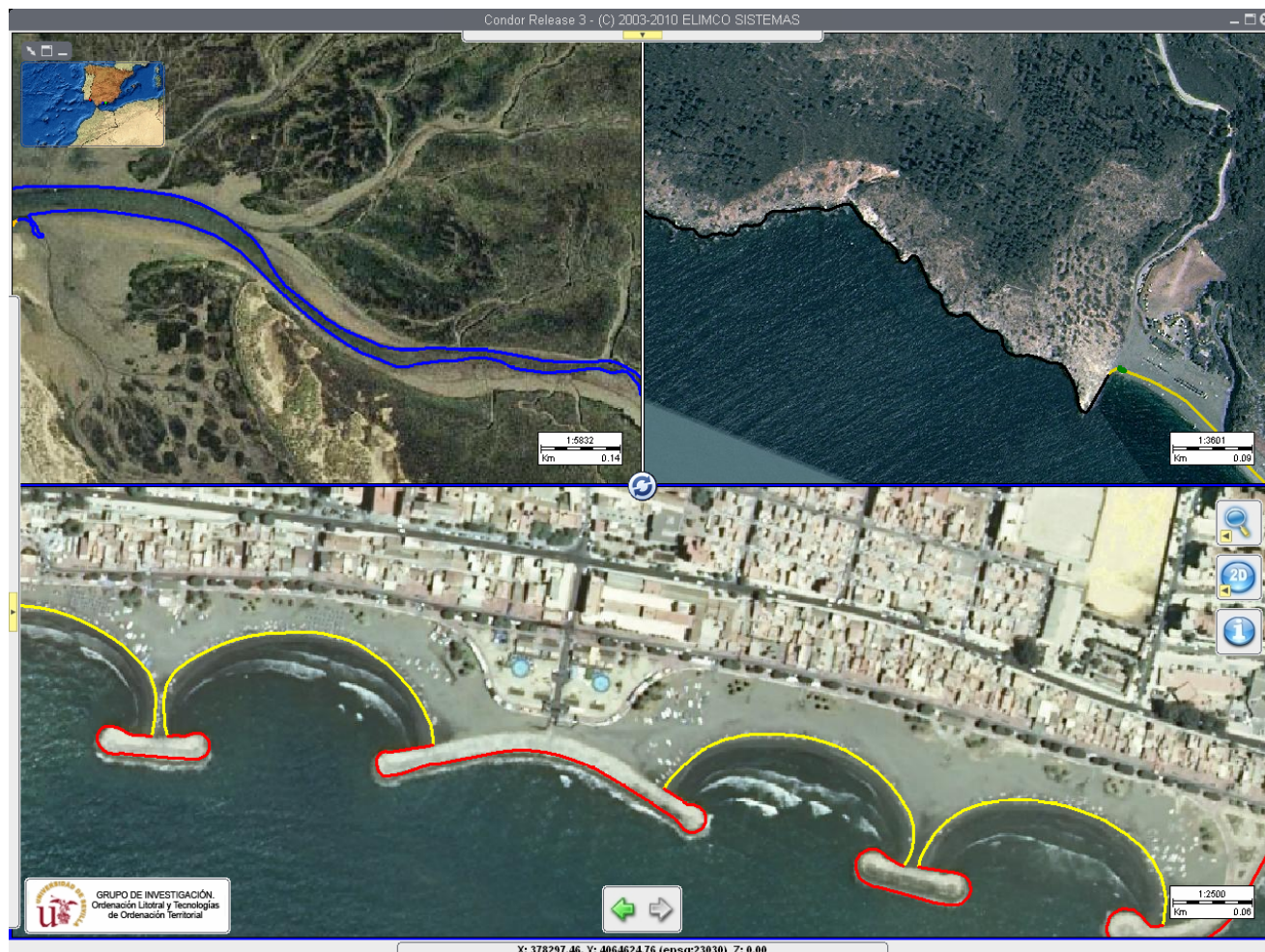
Figura 2. Criterios de fotointerpretación para estuarios y espacios marismenos, costa rocosa y acantilados, formaciones sedimentarias expuestas (playas) e infraestructuras.
