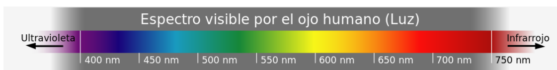
Figura 2.15. Espectro de radiación electromagnética en el rango visible. Imagen obtenida del repositorio Wikipedia Commons, https://commons.wikimedia.org/wiki/File:Electromagnetic_spectrum-es.svg bajo licencia de Dominio Público.
