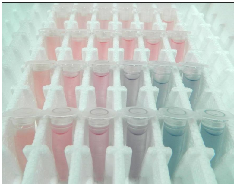
Figura 3.34. Fotografía con muestras de AuNPs preparadas en diferentes mezclas alcohol-agua. La primera fila corresponde a tert -butanol, con fracciones molares de 0.00, 0.10, 0.42, 0.50, 0.60 y 0.63. La siguiente corresponde al 2-propanol, con fracciones molares de 0.00, 0.10, 0.40, 0.57, 0.65 y 0.67. La tercera fila corresponde al etanol, cuyas fracciones molares son 0.00, 0.10, 0.40, 0.50, 0.60 y 0.73. La última corresponde al metanol, con fracciones molares de 0.00, 0.10, 0.40, 0.50, 0.60 y 0.80.
