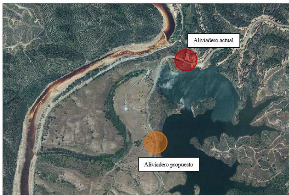
Ilustración 7-1. Emplazamiento del aliviadero propuesto
