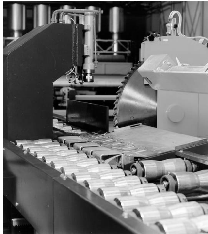
Fig. 6. Mesa de rodillos y sierra de barros.
