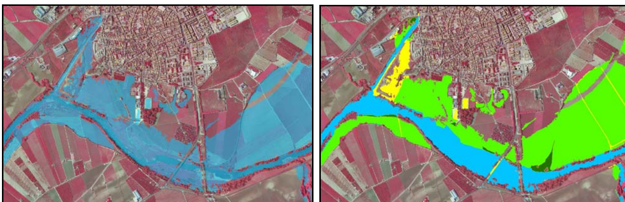
Figura 4. Ámbito de Trabajo: Lora del Río-Palma del Río. (a) Lámina de Agua en Cian semitransparente. (b) Lámina de agua con clasificación de uso del suelo afectado: Verde (Agrícola), Oliva (Forestal), Amarillo (Espacio Construido e Infraestructuras). En Cian, Ríos y embalses.
