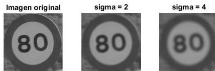
Figura 5-4: Efecto de aplicar un filtro Gaussiano sobre una imagen con distintos valores de \sigma
