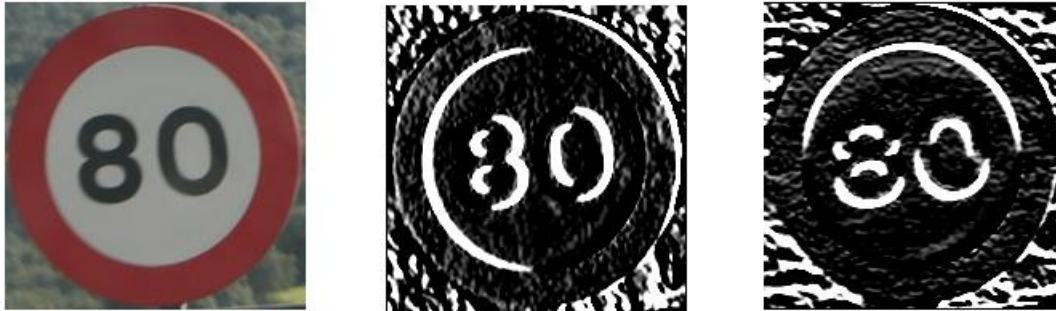
Figura 5-9: Ejemplo de aplicación del gradiente para buscar los bordes de una imagen
