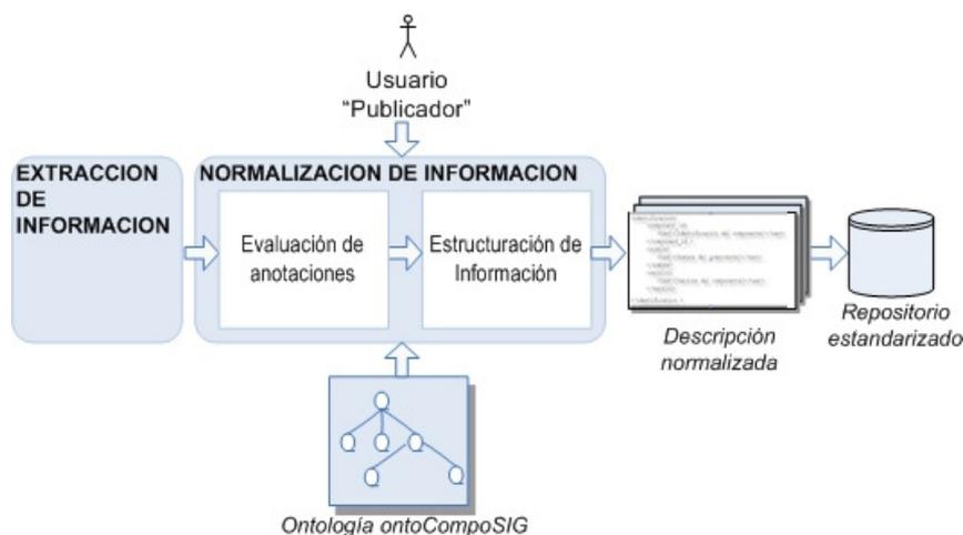
**Figura 3.** Detalle del Módulo 3: Normalización
