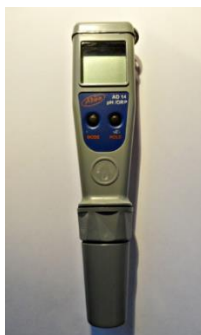
8. ábra. ADWA AD14 pH/ORP-mérő (Forrás: saját fotó).
