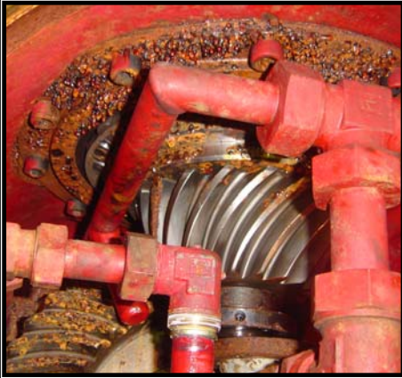
Fig. 2. Corrosión en el par de transmisión.
